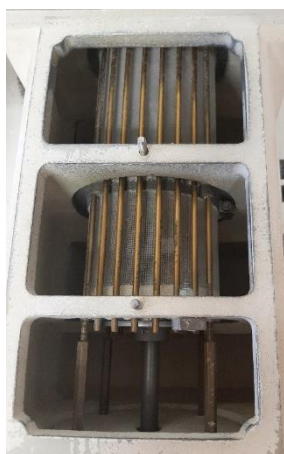
Figura 27: cilindri e setacci del molino di laboratorio per la macinazione del grano duro
