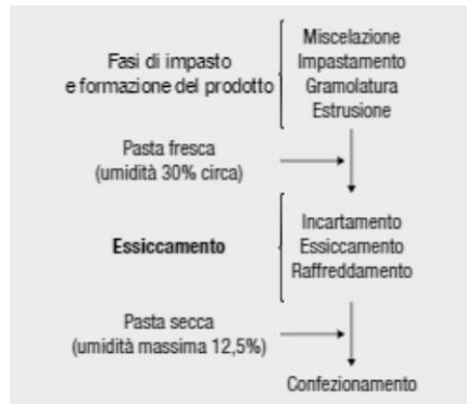
Figura 23: schema del processo di pastificazione
