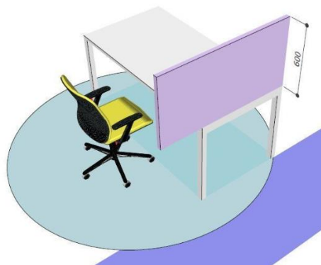
Figura 29: Postazione di lavoro per rispettare la distanza sociale ed evitare qualunque tipo di contatto con l'operatore vicino
