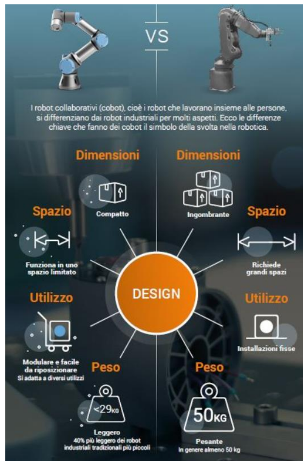
Figura 37: Differenza tra Robot tradizionali e Robot collaborativi
