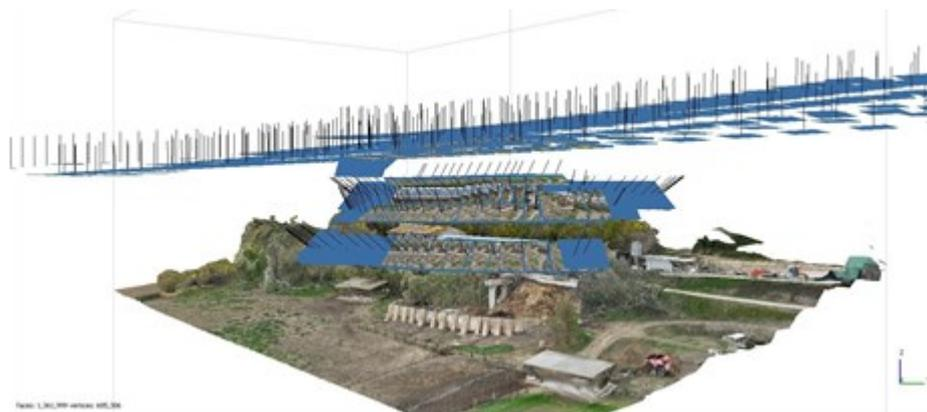
**Figura 4.2 Centro di presa delle camere: si notano sia le camere nadirali che oblique**
