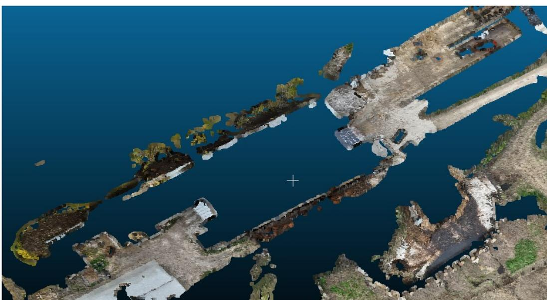
*Figura 4.11 Individuazione dei punti a terra da parte di CSF filter tool*
