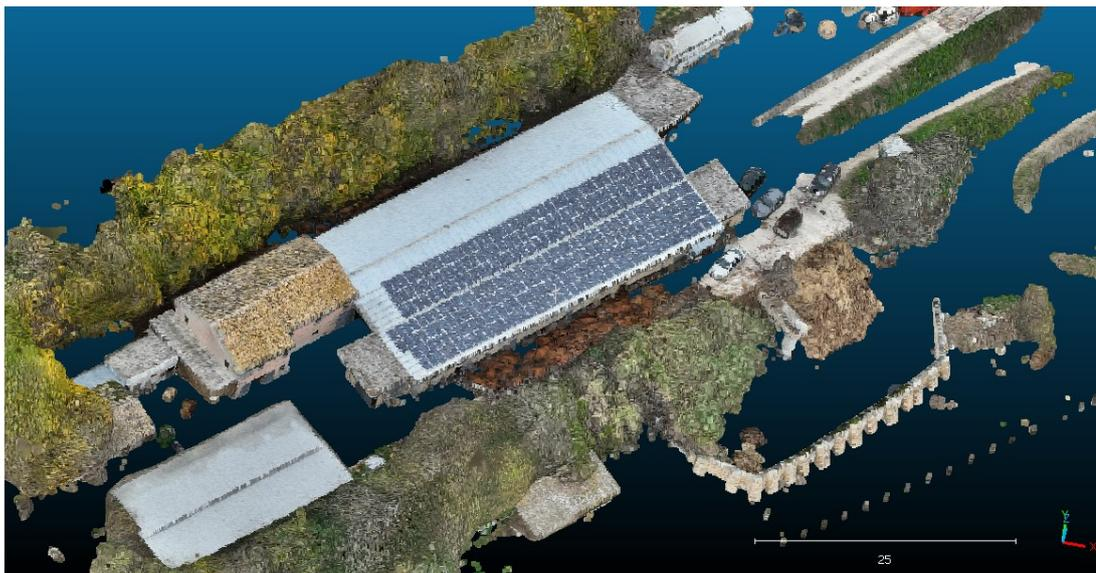
*Figura 4.10 Individuazione dei punti fuori terra da parte di CSF filter tool*
