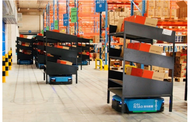
Figura 1.11: movimentazione all'interno del magazzino intelligente di Alibaba con utilizzo di robot AGV
