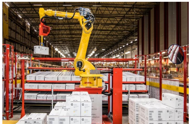
Figura 1.13: Pick and place con un robot nel magazzino intelligente di DHL
