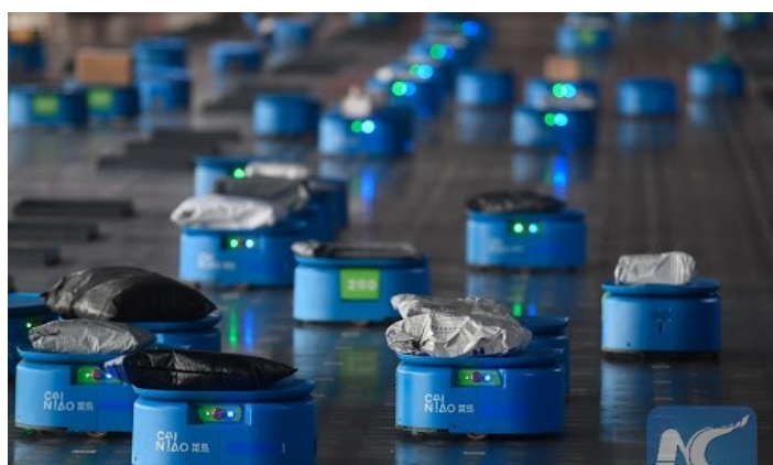
Figura 2.1: robot in funzione nella movimentazione di ordini all'interno del magazzino di Alibaba
