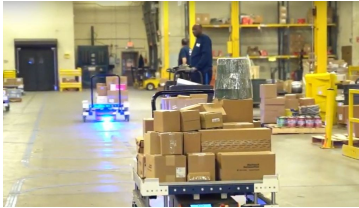
Figura 2.2: robot AGV order to man (O2M) in movimento dopo aver preso tutti gli ordini.
