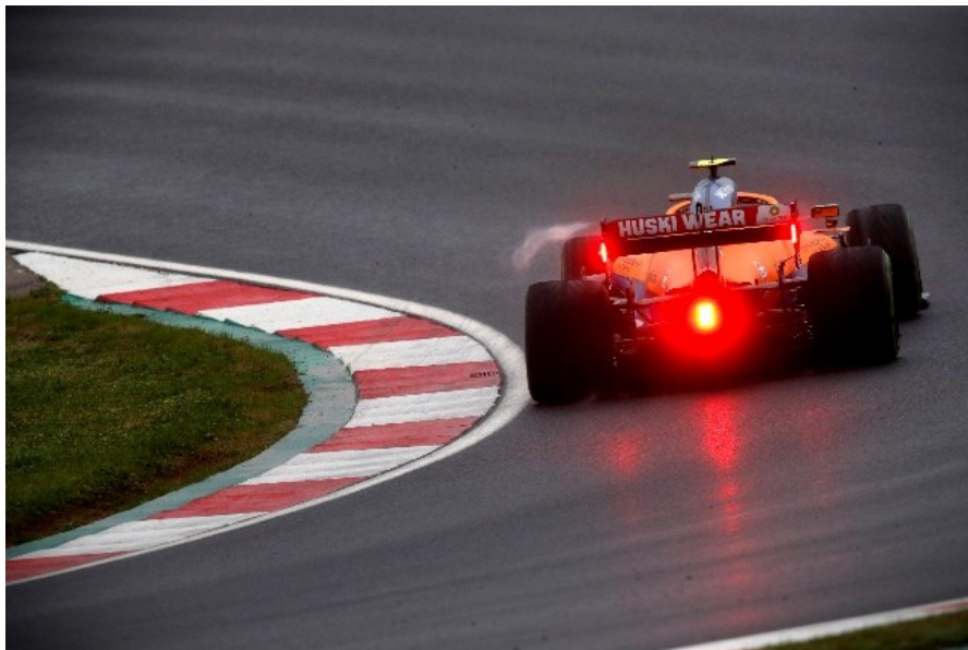
Figura 2.11 - Vortici d'estremità sull'ala posteriore
