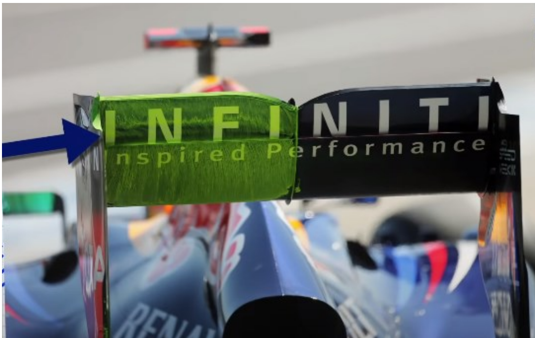
Figura 105: Flusso separato nella zona indicata dalla freccia
