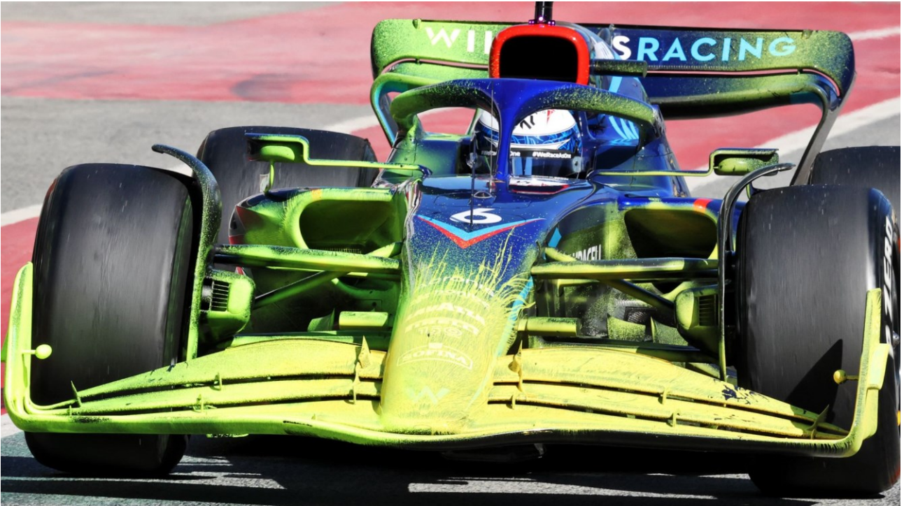
Figura 100: Flow Viz Paint sulla FW44
