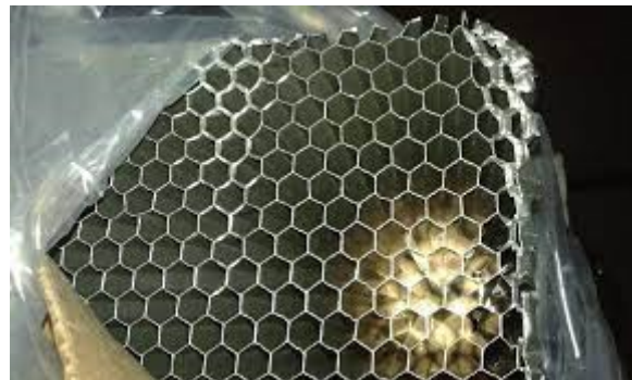
Figura 112: Honeycomb per smaltire il calore e pulire i flussi
