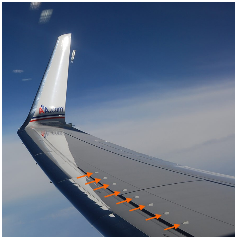
Figura 26: Vortex generator sulle ali di un aereo
