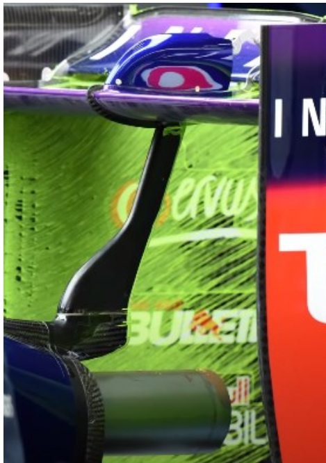
Figura 102: Flusso attaccato laminare
