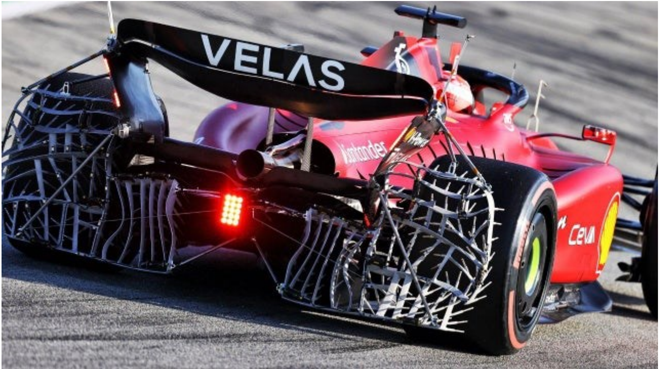
Figura 106: Rastrelliera utilizzata dalla F1-75 nei test invernali in Bahrein
