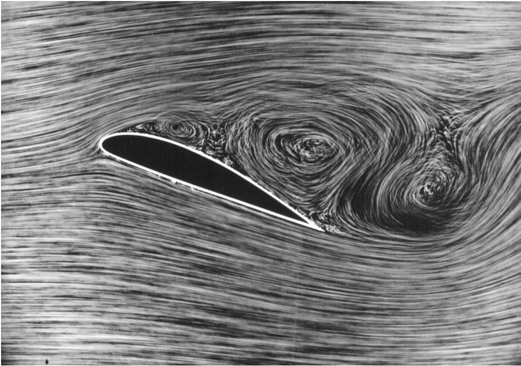
Figura 38: Stallo visto in galleria del vento
