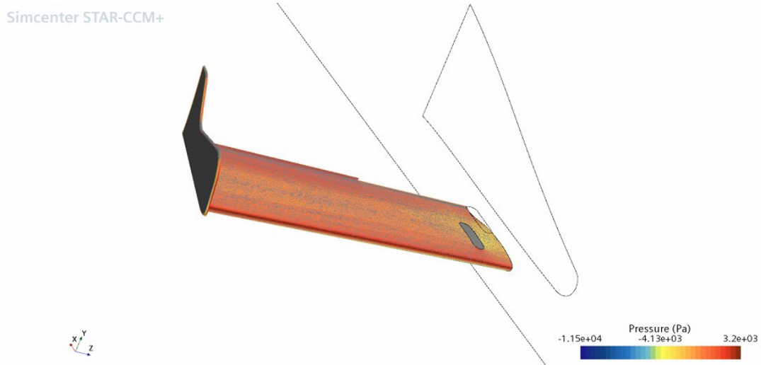
Figura 197: Geometria FEM e geometria CFD sovrapposte nella scena di pressione del software CFD
