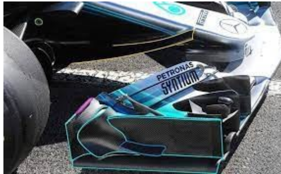
Figura 57: Deviatori di flusso sull'ala anteriore di una mercedes W9
