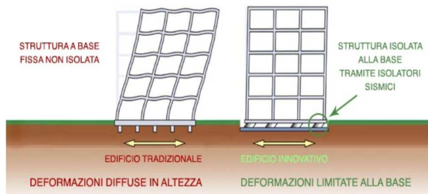
Figura 3.1: Confronto cinematico tra edificio a base fissa e isolato alla base.
