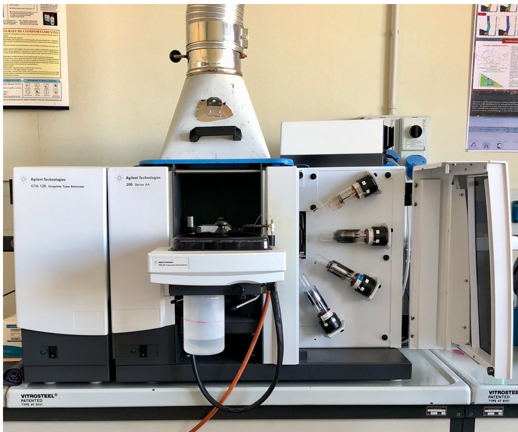
Fig. 10. Spettrofotometro di Assorbimento Atomico 240 AA e lampade multielemento
