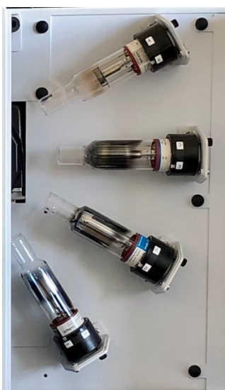
Fig. 15. Lampade multielemento a catodo cavo (Agilent Technologies)
