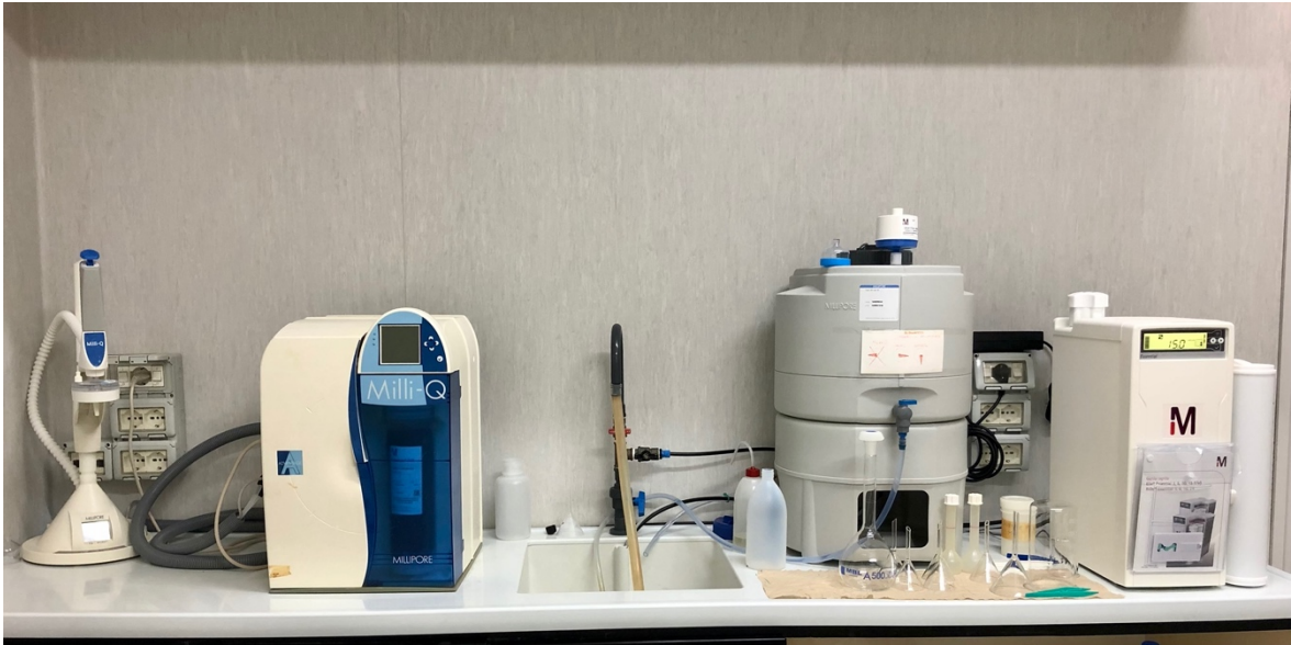
Fig. 3. Sistema Millipore Midi con trattamento a due stadi
