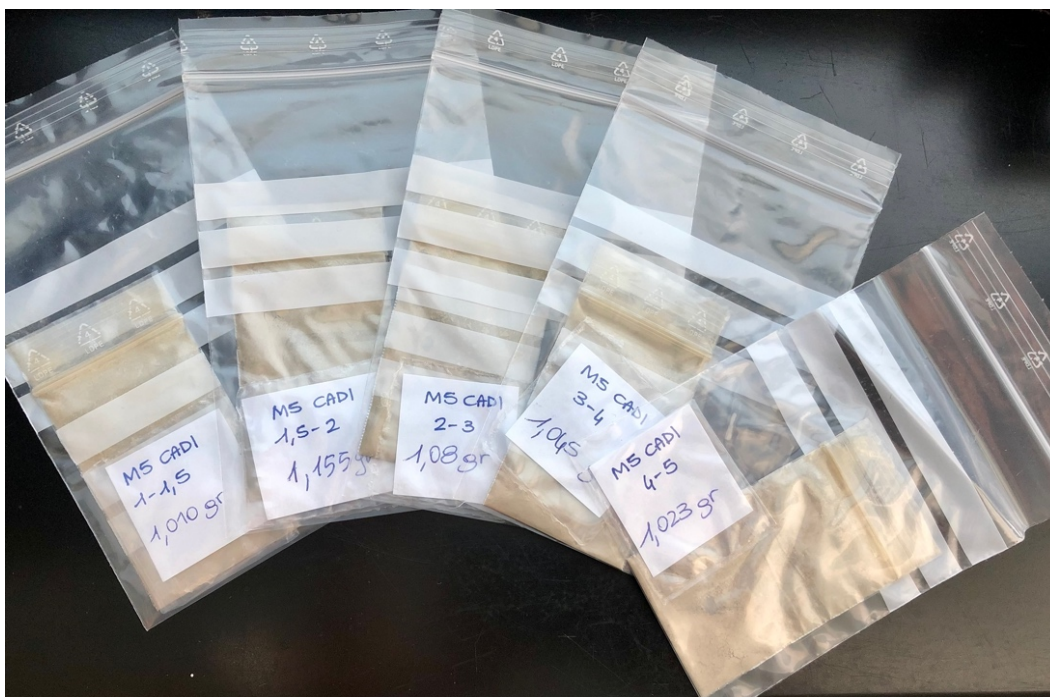
Fig. 5. Vari sub-campioni polverizzati della carota CADI M5, contenuti singolarmente in doppia busta siglata
