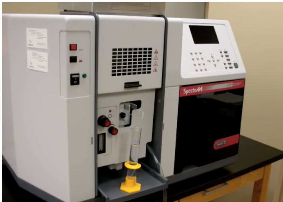
Fig. 11. Spettroscopia ad Assorbimento Atomico a Fiamma
