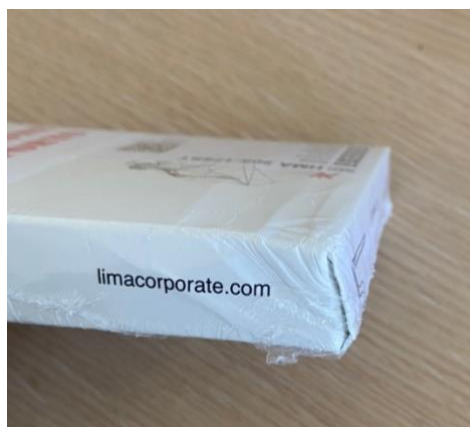
Figura 41: deformazione da compressione dell'astuccio contenente "Cambre"
