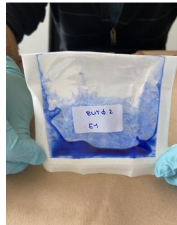
Figura 48: "Dye Penetration Test" lato 1 busta esterna
