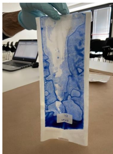
Figura 52: “Dye Penetration Test” lato 1 busta esterna
