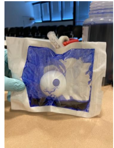
Figura 59: "Dye Penetration Test" lato 3 busta esterna
