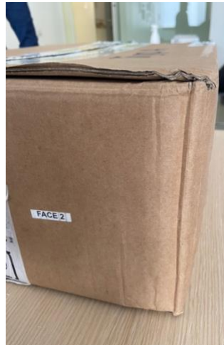
Figura 36: deformazione da compressione dell'unità di spedizione a seguito della simulazione del trasporto
