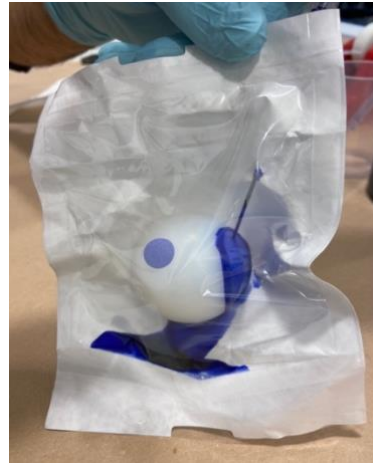
Figura 56: "Dye Penetration Test": iniezione dell'inchiostro tramite ago
