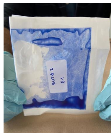
Figura 50: "Dye Penetration Test" lato 3 busta esterna
