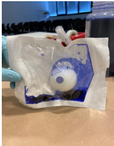
Figura 58: "Dye Penetration Test" lato 2 busta esterna
