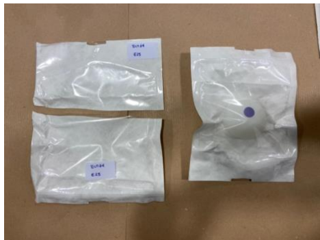
Figura 55: taglio della busta esterna del confezionamento primario contenente "SLP" previo "Dye Penetration Test"
