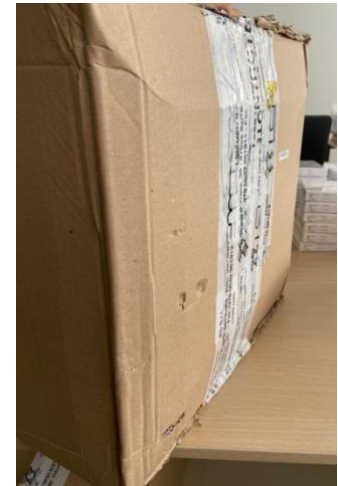
Figura 37: deformazione da urto dell'unità di spedizione a seguito della simulazione del trasporto
