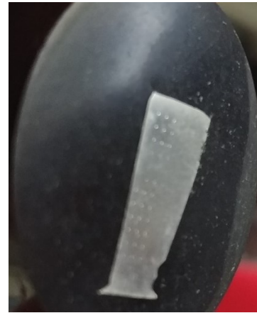
Fig. 34 d Campione di acciaio inox 316L DED V400 TQ y-z dopo la prova di micro-durezza effettuata con un carico di 500 gf applicato per 10 secondi
