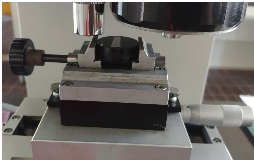
Fig. 32 Campione di acciaio inox 316L DED V600 TQ y-z montato sul micro-durometro e pronto per le prove di micro-durezza
