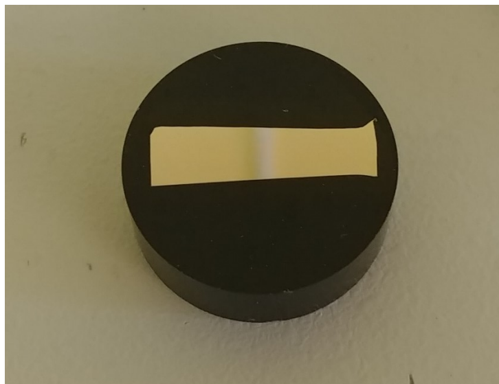
Fig. 29 Superficie del campione al termine delle fasi di lucidatura manuale e automatica
