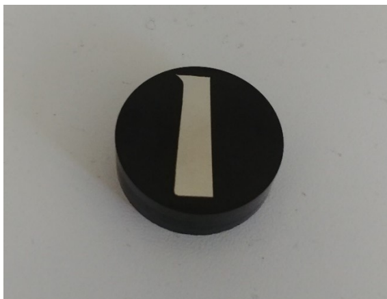
Fig. 34 a Campione di acciaio inox 316L DED V600 TQ y-z prima della prova di micro-durezza
