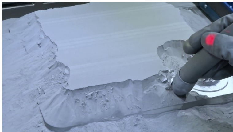
Fig. 7 Fase di rimozione della polvere metallica in eccesso alla fine del processo L-PBF
