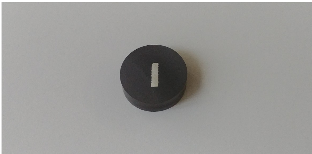
Fig. 35 Campione di acciaio inox 316L DED V400 z-y TT, trattato termicamente
