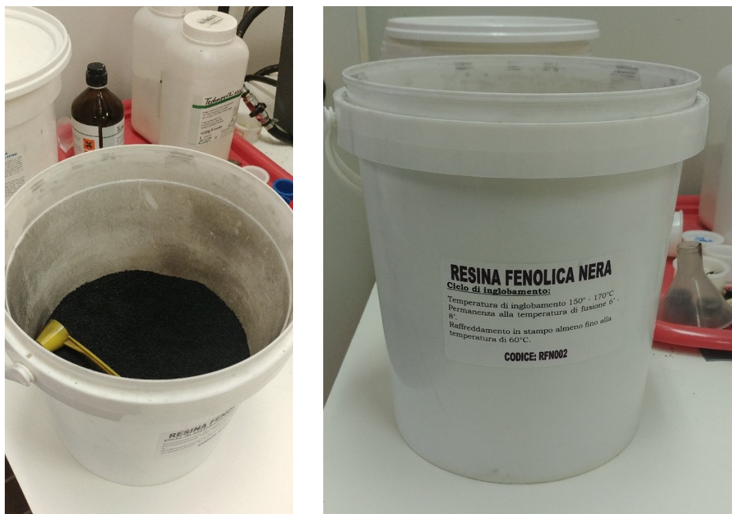
Fig. 25 (a) Resina fenolica nera utilizzata nel processo di inglobatura, (b) indicazioni sul corretto utilizzo della resina
