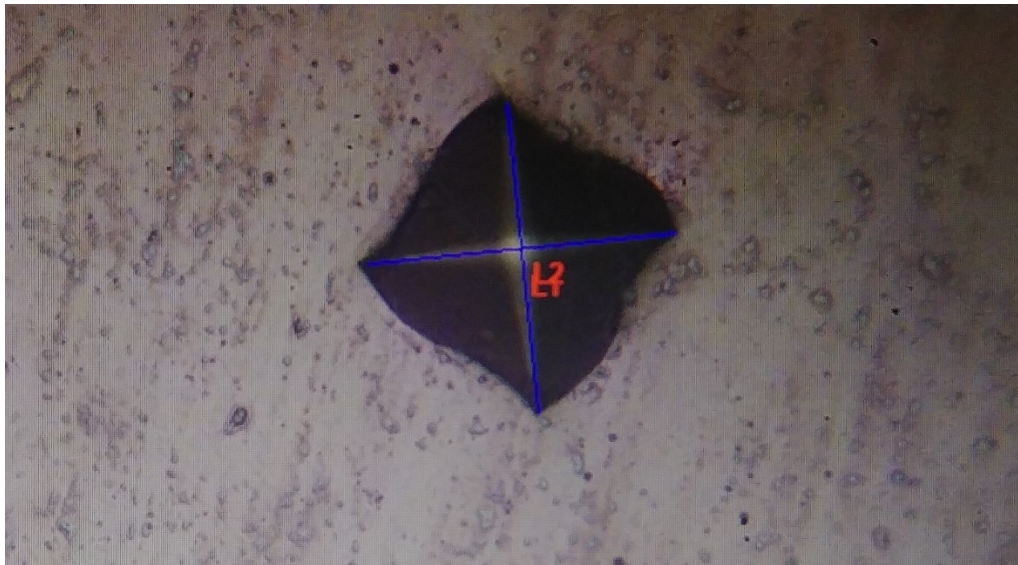
Fig. 33 Immagine ingrandita dell'impronta lasciata sulla superficie del campione dall'indentatore Vickers, con le diagonali evidenziate in blu e indicate con L_1 e L_2
