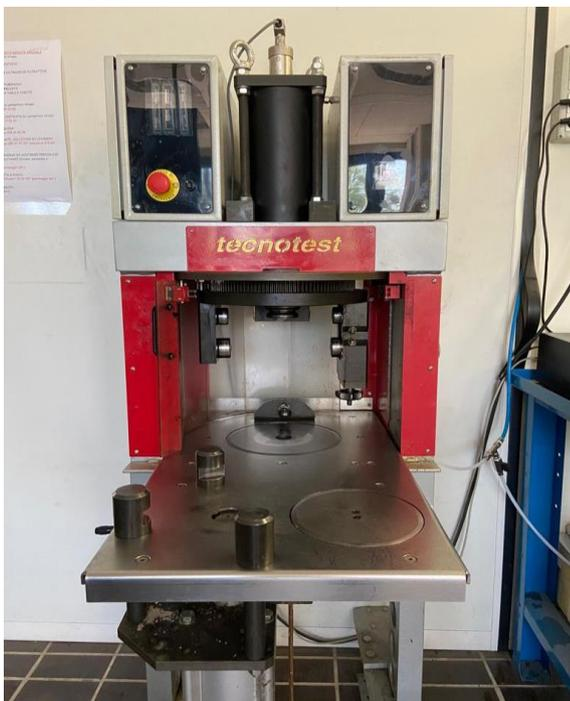
*Fig.3.5 Pressa a taglio giratoria in laboratorio*
