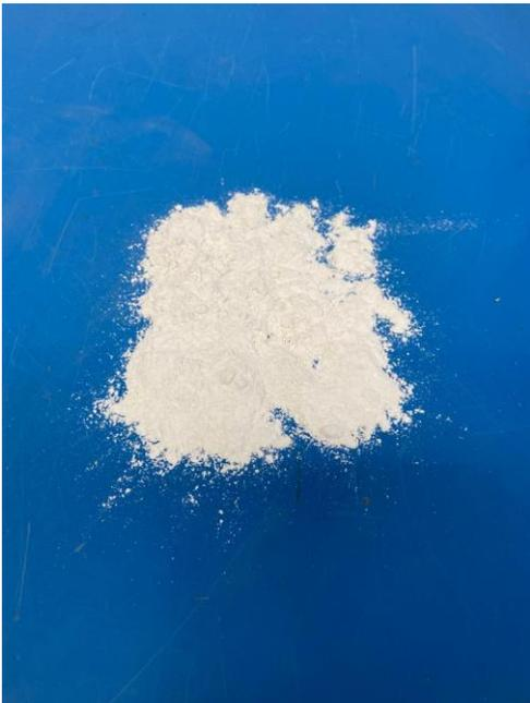
*Fig.4.7 Filler Calcareo utilizzato nelle miscele*
