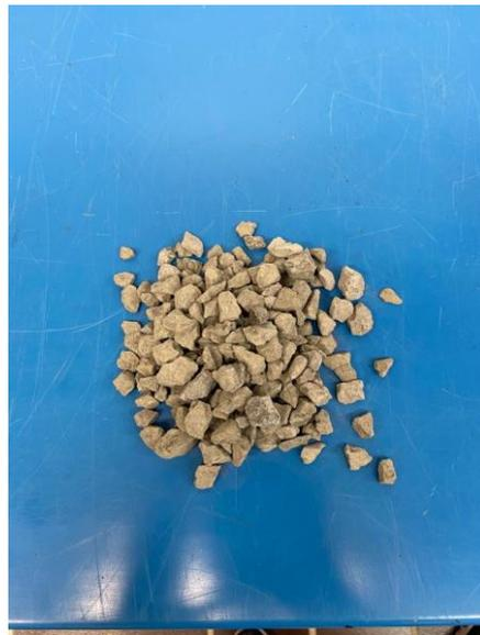
Fig.4.4 Basalto 8/12 utilizzato nelle miscele
