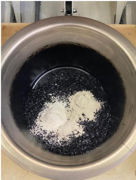
*Fig.3.3 Aggiunta del filler calcareo e di recupero*
