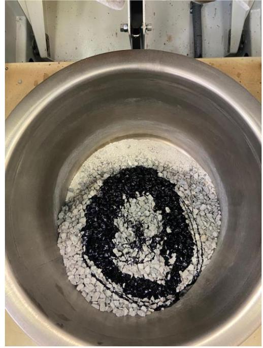
*Fig.3.2 Aggiunta del bitume liquido*
