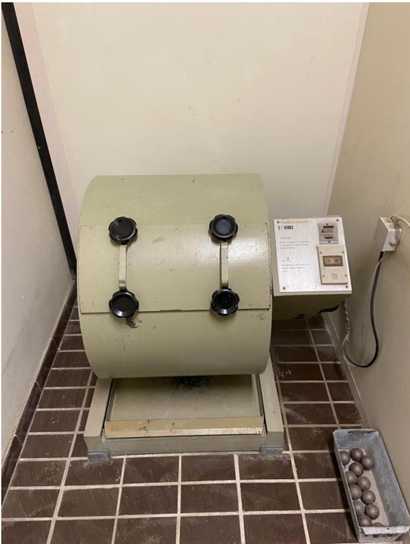
Fig.3.9 Cilindro usato per la prova Cantabro
