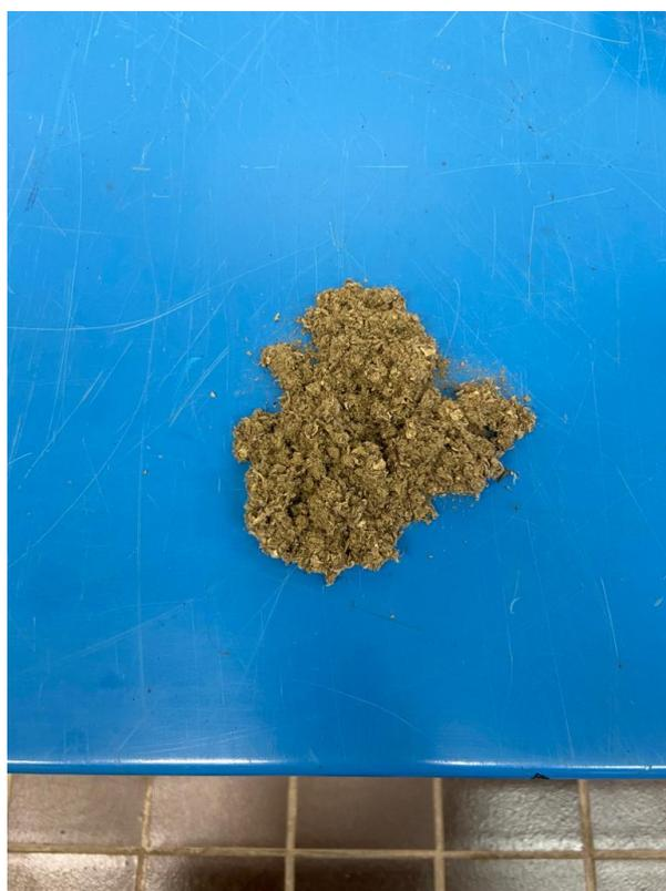
*Fig.4.11 Fibre di tessuto utilizzate nelle miscele*
