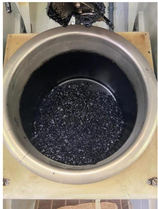
*Fig.3.4 Conglomerato bituminoso finale pronto per lo sporzionamento*
