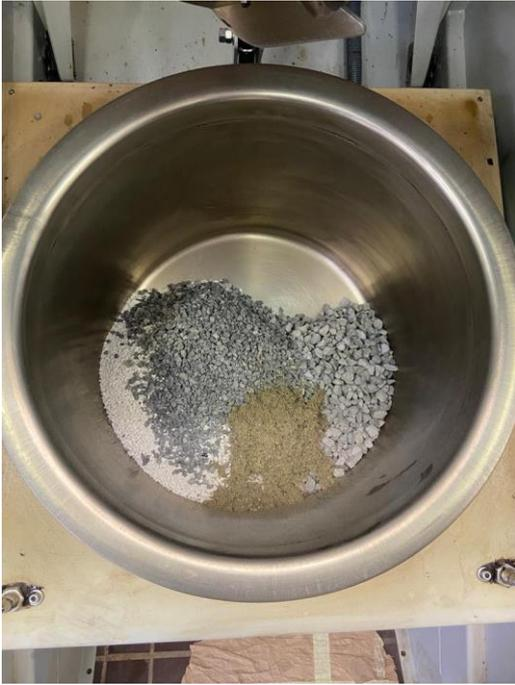
*Fig.3.1 Aggiunta degli aggregati riscaldati e fibre di tessuto nel miscelatore*
