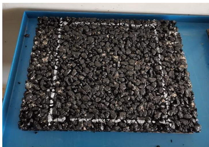
Figura 3.51. Output del Roller Sector Compactor
