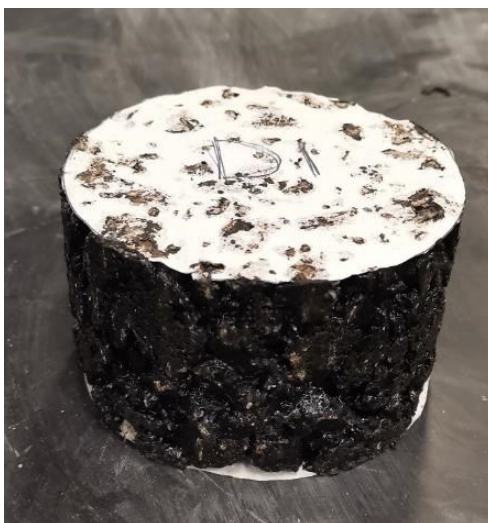
Figura 3.58. Output della compattazione Marshall
