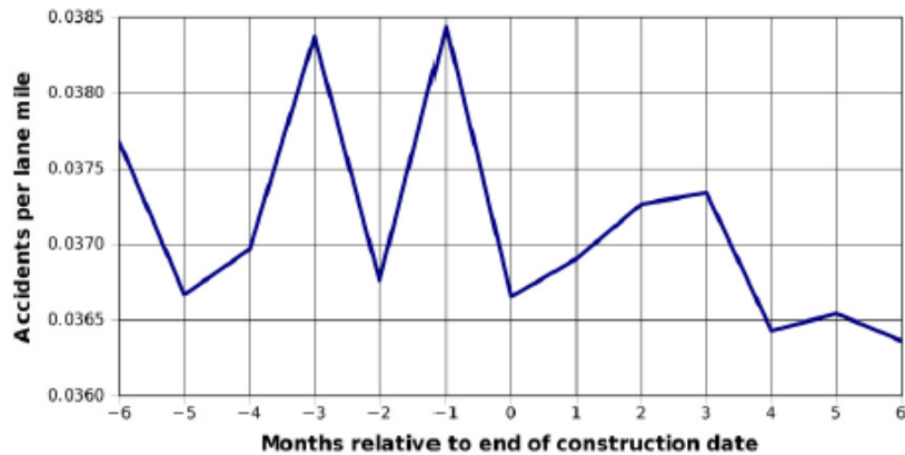
Figura 2.8. Analisi incidenti prima e dopo l'introduzione dei conglomerati bituminosi porosi (A. Smit et al., 2013)
