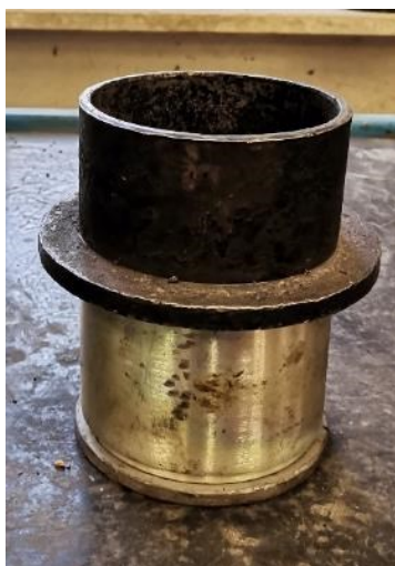
Figura 3.55. Composizione fustella per compattatore Marshall
