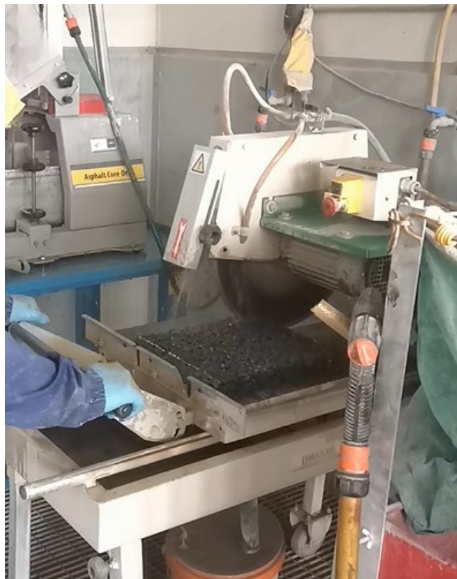
Figura 3.52. Esecuzione taglio con sega raffreddata ad acqua
