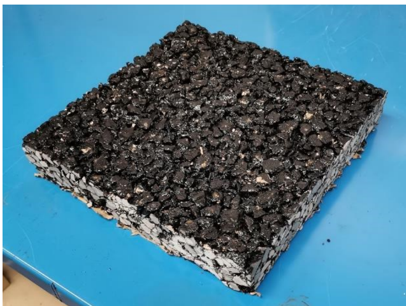
Figura 3.53. Piastra tagliata di dimensioni prescritta dalla prova
