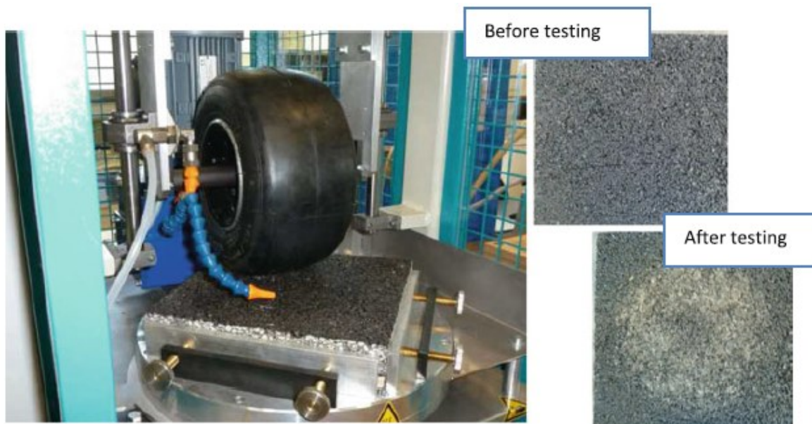
Figura 2.15. Dispositivo DSD e piastra testata (Visscher and Vanelstraete, 2015)
