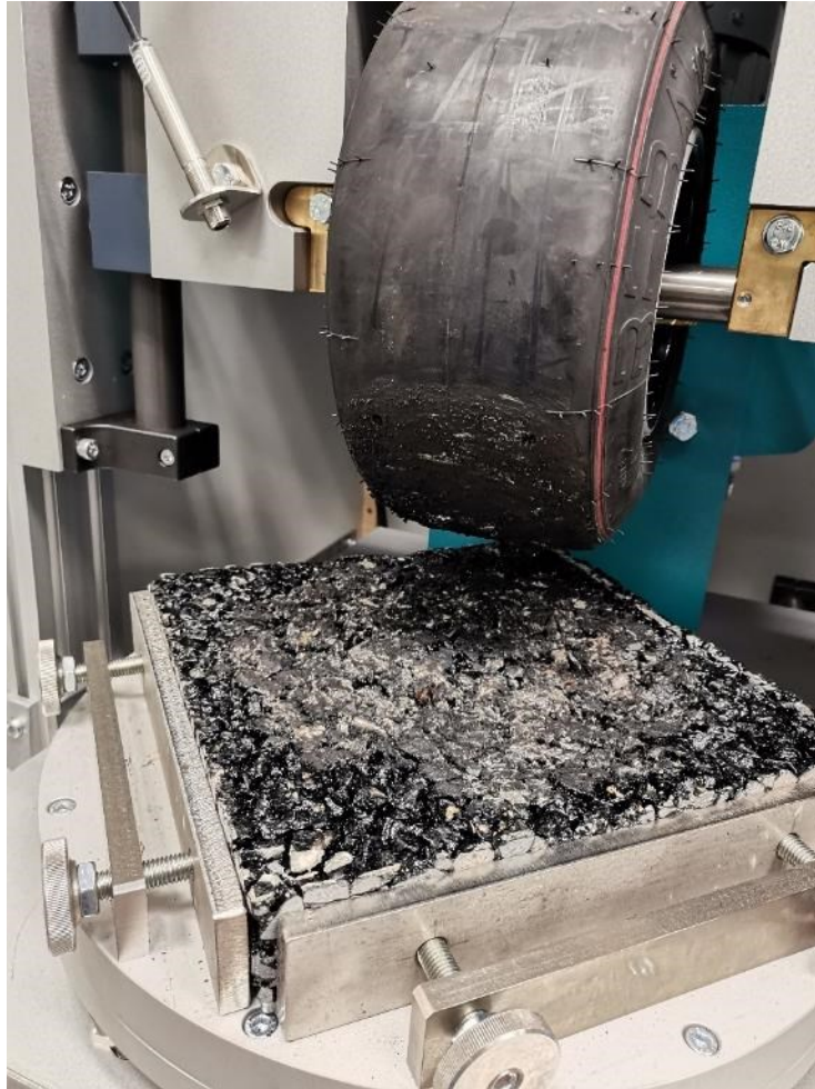
Figura 3.60. prova in esecuzione con piastra posizionata sul supporto
