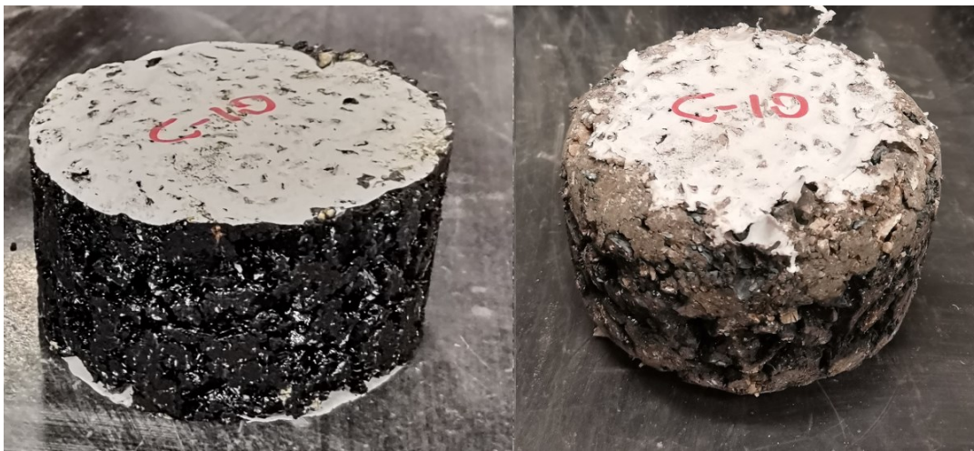
Figura 3.65. Analisi visiva del provino dopo l'esecuzione della prova Cantabro
