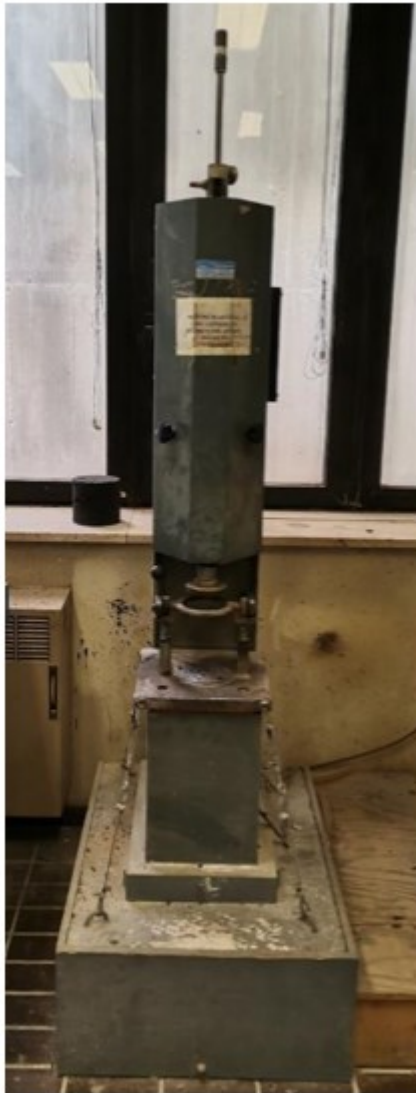
Figura 3.54. Compattatore ad impatto e dimensione provino di output finale
