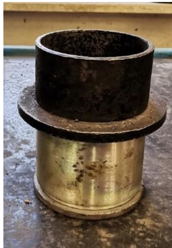
Figura 3.57. Cassero per la compattazione di provini con il macchinario Marshall
