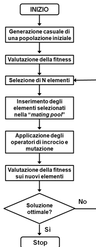
Figura 3.6: Schema generale di ottimizzazione mediante algoritmo genetico.
