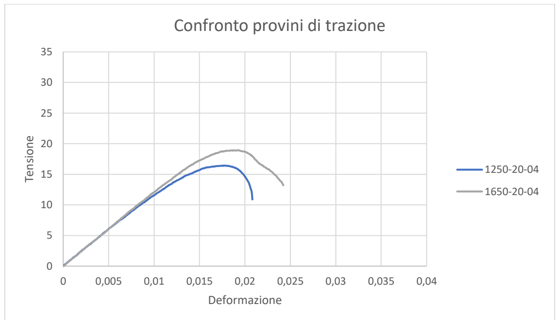
Figura 5.42 – Confronto tra le curve tensione-deformazione dei provini ottenuti con parametri di processo di 1250-20-04 e 1650-20-04
