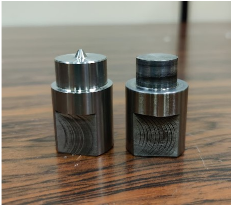
Figura 3.22-Confronto tra utensile pin e pinless utilizzato nelle prove in laboratorio
