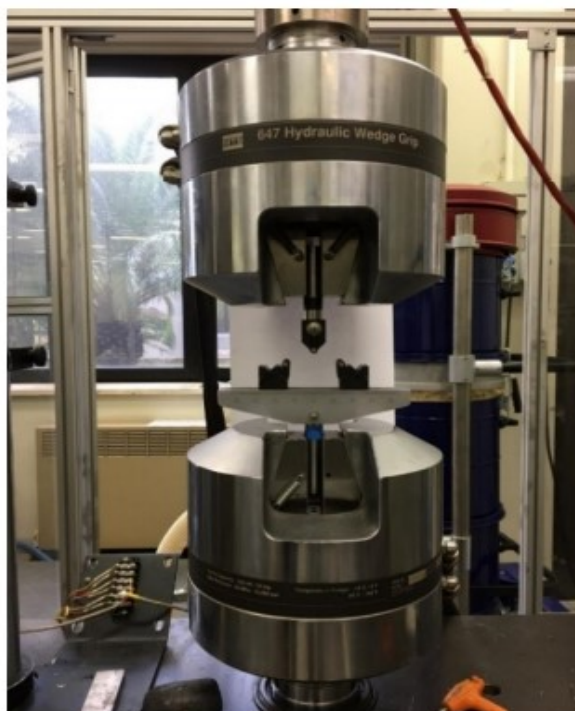
Figura 4.62- Rappresentazione della macchina di prova universale MTS 810 utilizzata per la verifica dei provini a piegatura
