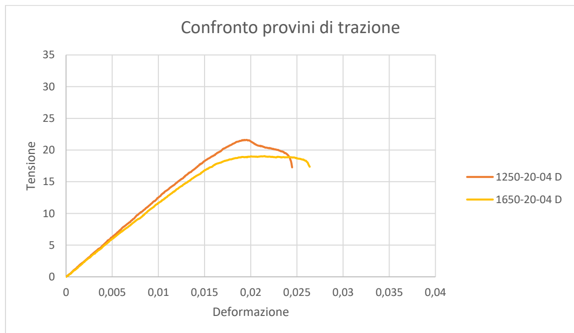
Figura 5.42-Confronto tra le curve tensione-deformazione dei provini double side ottenuti con parametri di processo di 1250-20-04D e 1650-20-04D
