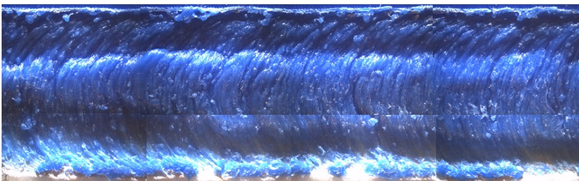
Figura 5.23-Osservazione allo stereomicroscopio con ingrandimento 8x del cordone di saldatura nelle condizioni 1650-40-04 nel lato della prima passata
