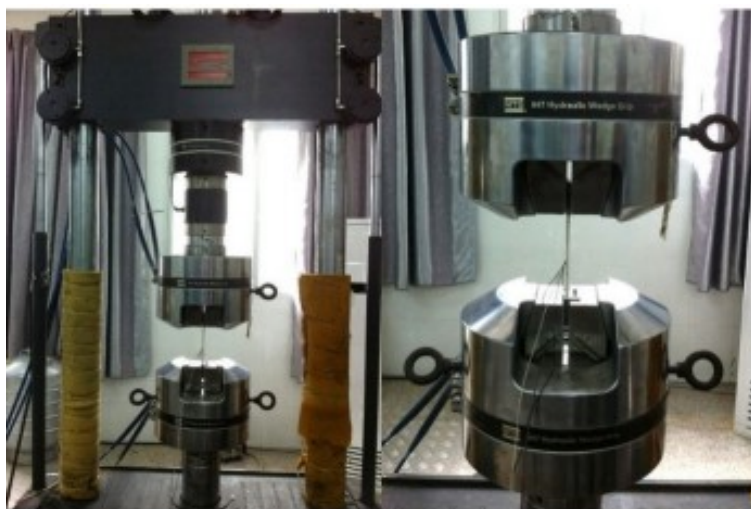
Figura 4.71-Macchina di prova MTS 810 allestita per prove di trazione
