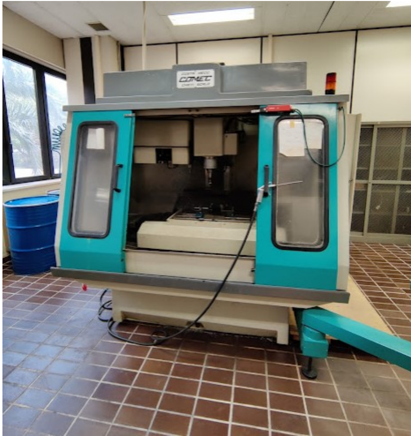
Figura 4.31-Macchina CNC a tre assi controllati usata per eseguire le prove di saldatura
