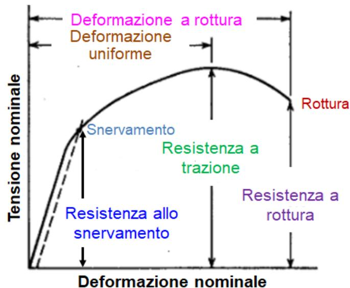
Figura 4: curva Tensione-Deformazione nominale, evidenziando i punti critici
