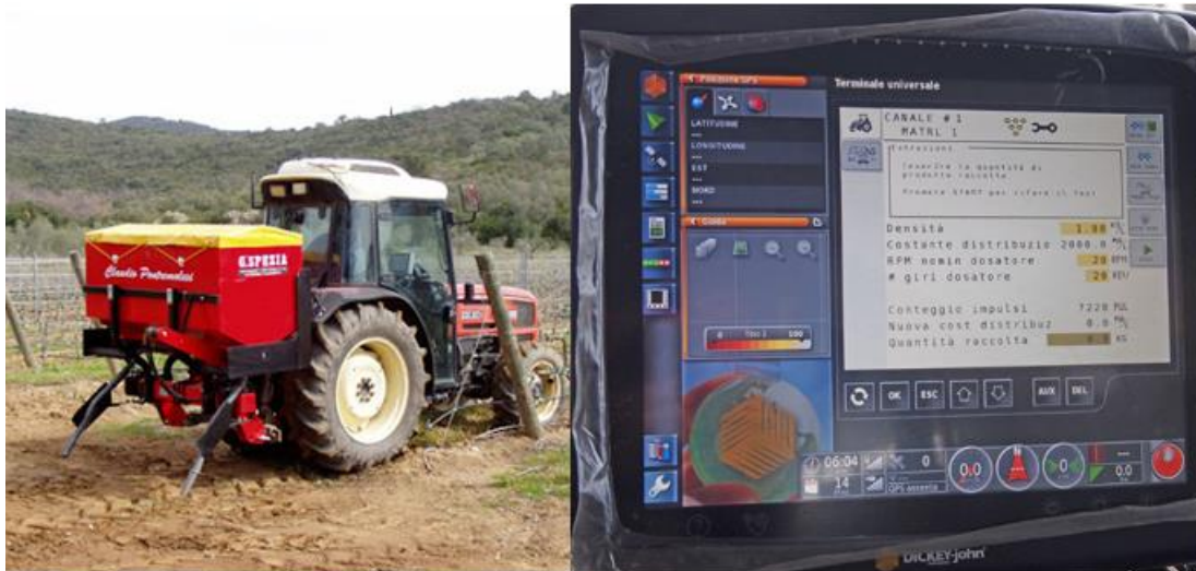
Figura 1-1 – Alla destra della figura è rappresentata una spandiconcime a rateo variabile durante il suo utilizzo mentre a destra troviamo la centralina di comando con il rispettivo terminale video. (Fonte - www.tecnovict.com ).
