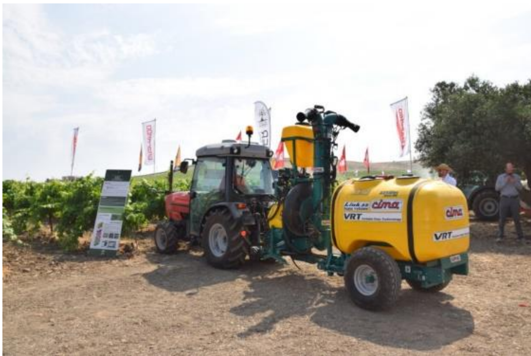
Figura 1-3 - Nella figura troviamo un atomizzatore pneumatico a rateo variabile CIMA in funzione durante una giornata dimostrativa in pieno campo (fonte - www.macchineagricolenews.it )
