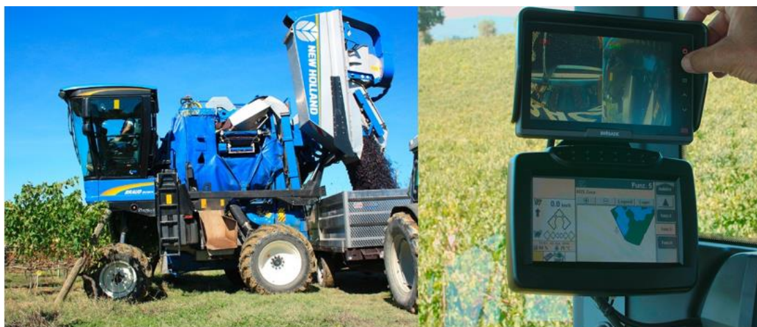
Figura 1-4– A sinistra abbiamo una vendemmiatrice selettiva automatizzata sito-specifica e a destra la centralina di controllo con il rispettivo terminale video e il terminale video delle telecamere di sorveglianza degli organi di lavoro (fonte: ProfessioneVite: (Vai & Cavallaro, s.d.))
