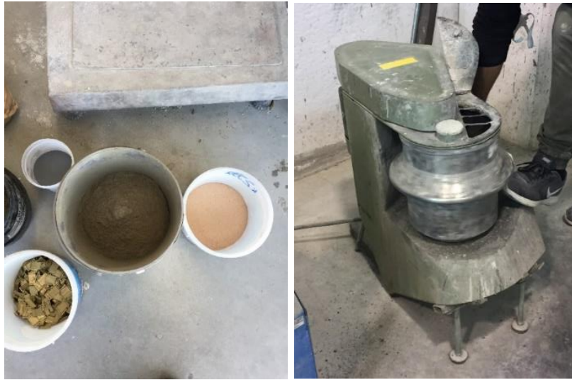
Fig.20 - Pesatura componenti calcestruzzo e Miscelazione impasto
