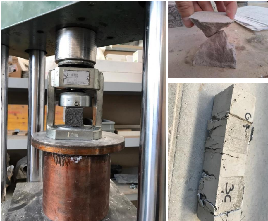
Fig.26 - Prova a compressione provini 4x4x16 cm 3
