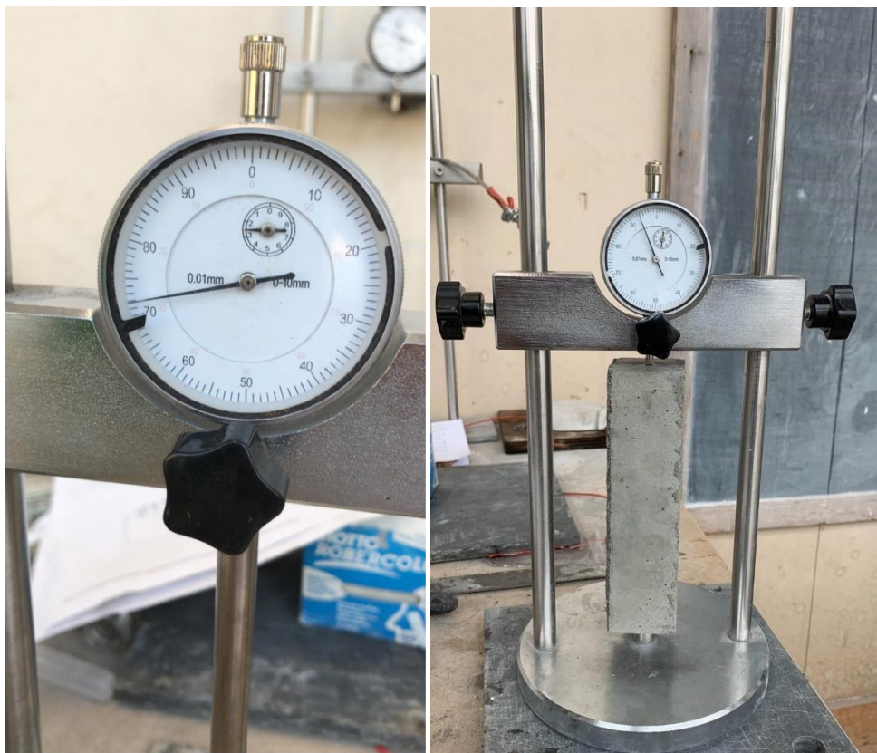
Fig.26 - Prova determinazione ritiro assiale 4 \times 4 \times 16 \text{ cm}^3
