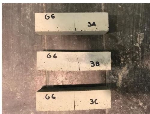
Fig.25 b Prova a flessione provini con fibre 4x4x16 cm 3
