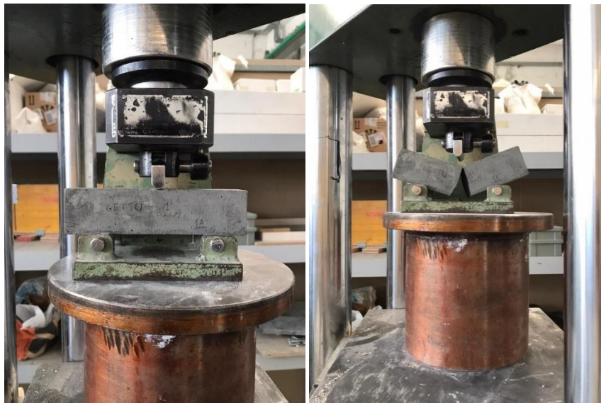
Fig.24 Prova a flessione provini 4x4x16 cm 3
