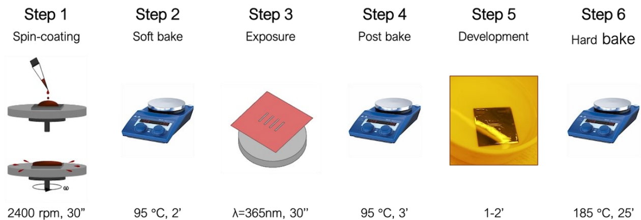
Figura 6-Processo di formatura primo livello.
