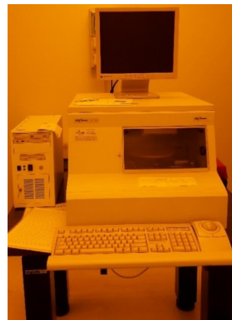
Figura 12b-Profilometro a contatto KLA Tencor P-15.
