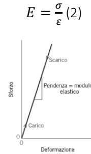
Figura 3b-Focalizzazione sulla porzione tensione-deformazione nel comportamento elastico lineare.
