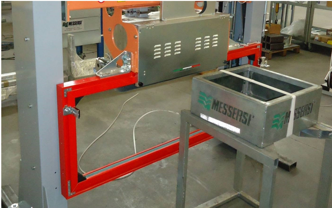
Figura 9. FOTO DI UN ARCO IN TELO COSTRUITO TRAMITE L'UTILIZZO DEL CONFIGURATORE DI ARCHI CON POSIZIONE TESTA REGGIATRICE CENTRALE
