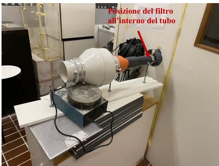
Figure 16.1, 16.2, 16.3. Configurazione dell'impianto di prova e strumentazione utilizzata per il test di efficienza del filtro.
