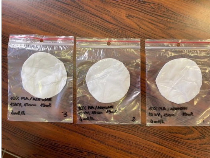
Figura 17. Filtri "10%PLA (1)", "10%PLA (2)", "10%PLA (3)" testati nella prova.
