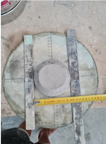
Figura 13- esempio di misura dello "slump"
