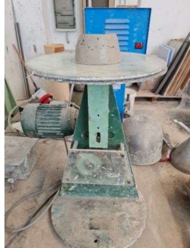
Figura 14- Strumentazione per lo "Slump Test"
