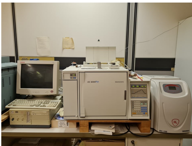
Figura 40- Gascromatografo collegato all'interfaccia software e alla macchina per l'idrolisi
