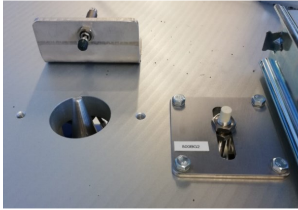
Figura 102 Sensori per il bloccaggio dei vassoi
