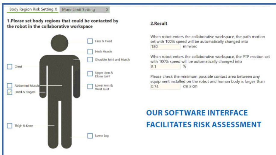
Figura 5 Impostazioni di sicurezza nel TMFlow
