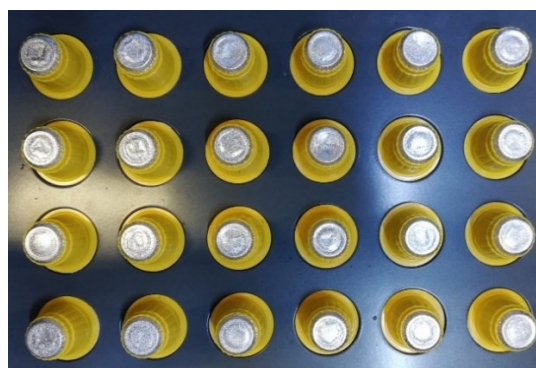
Figura 188 Distorsione dell'immagine rilevata dalla camera 2D
