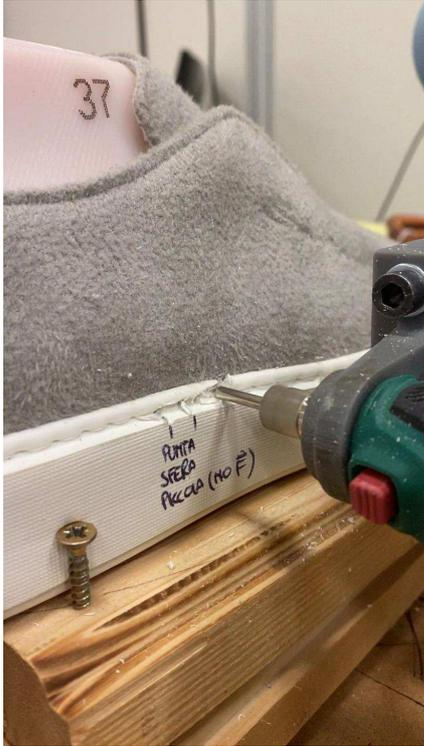
(a) Lavorazione con punta sferica tramite cobot
