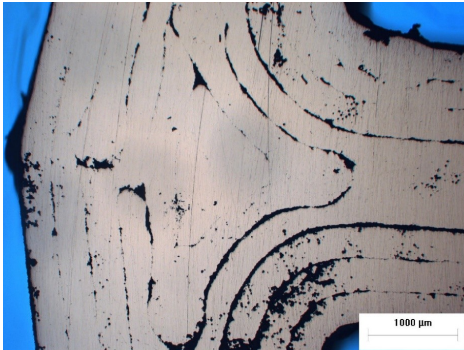
Figura 3.3: Provino 5.1_80 As-Sintered, linee di deposizione
