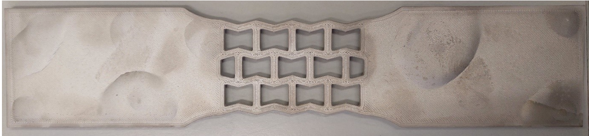
Figura 3.1: Difetti sulla superficie del provino
