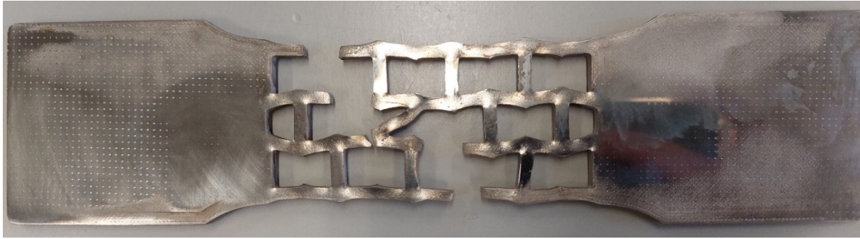
Figura 3.18: Frattura del provino 3.1_70
