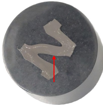
Figura 3.22: Superficie su cui è stata misurata la durezza
