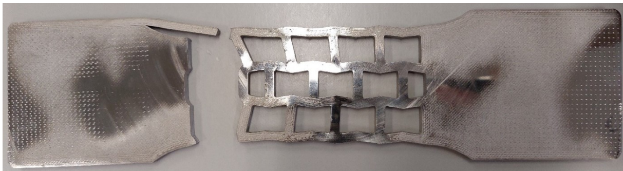
Figura 3.17: Frattura del provino 5.1_80
