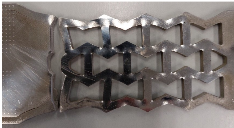
Figura 3.16: Frattura del provino 1.1_60
