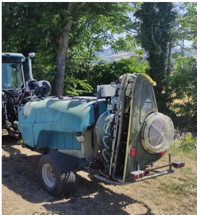
Figura 12 – Sensore LiDAR applicato ad un atomizzatore standard
