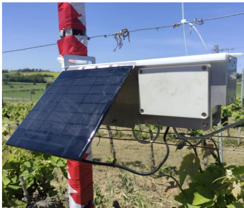
Figura 21 - Pannello solare per la ricarica automatica della batteria
