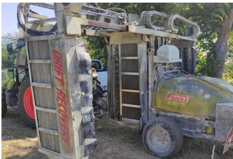
Figura 11 – Atomizzatore a tunnel con dispositivo di recupero
