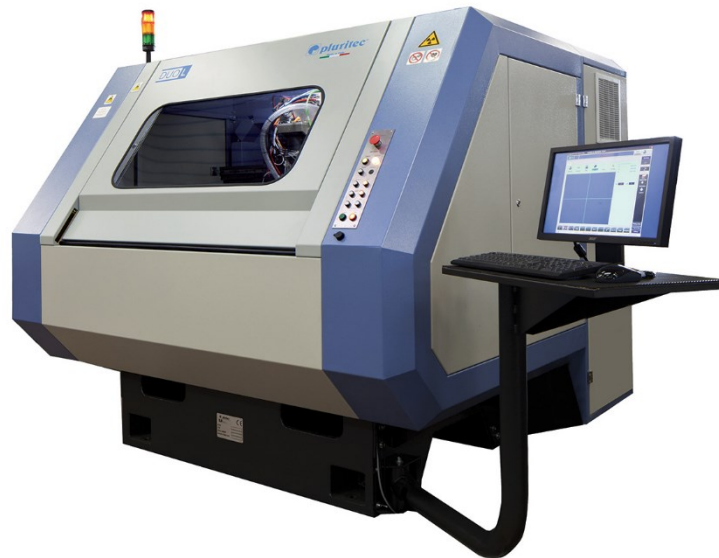
Figura 4: Macchina di lavorazione PCB di Pluritec
