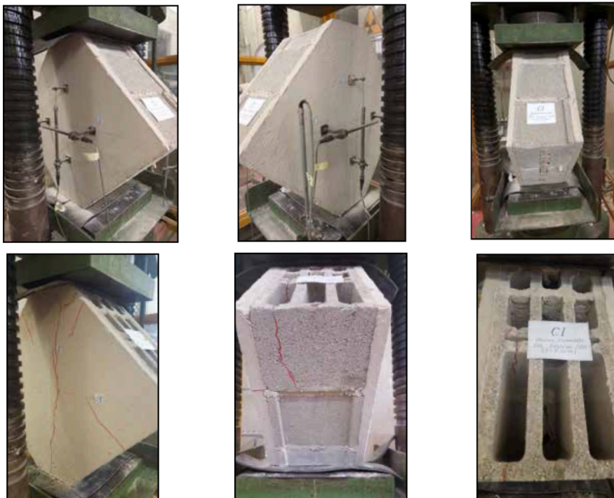
Figura 4.8 Provino C1.2 sotto prova di Compressione Diagonale
