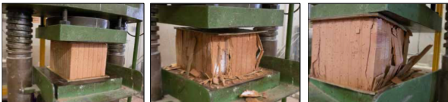
Figura 3.3 Prova di compressione semplice su un blocco Poroton
