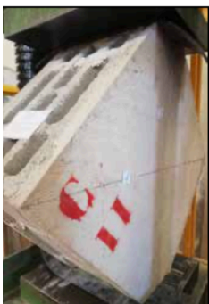
Figura 4.16 Provino C 2.1 sotto prova di Compressione Diagonale
