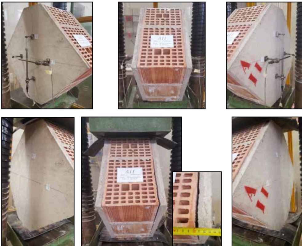
Figura 4.11 Provino A2.2 sotto prova di Compressione Diagonale
