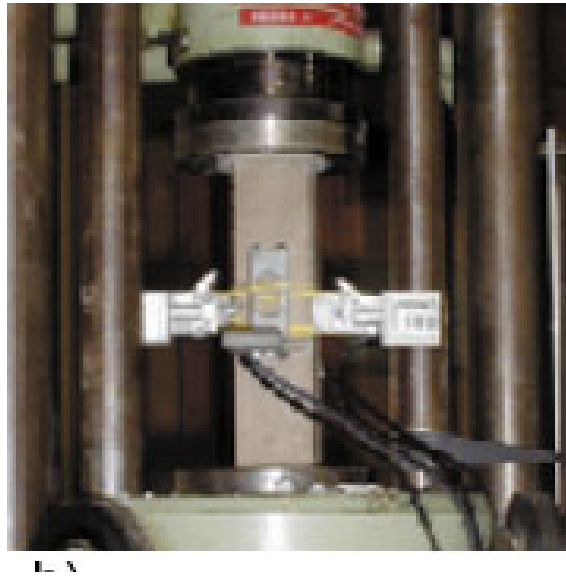
Figura 3.9 - Provino di malta sottoposto a compressione
