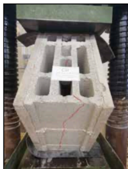
Figura 4.16 Provino C 2.1 sotto prova di Compressione Diagonale
