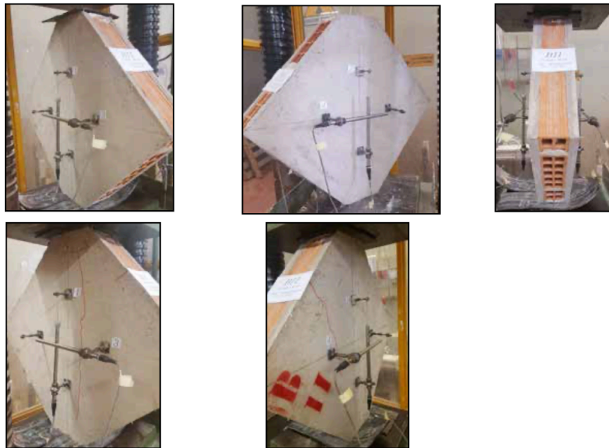
Figura 4.14 Provino B 2.2 sotto prova di Compressione Diagonale
