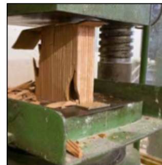
Figura 3.5 Prova di Compressione su un blocco Forato
