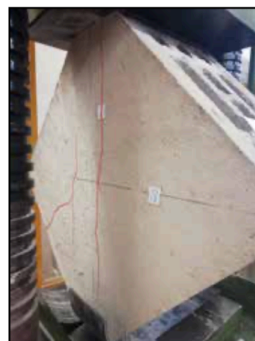
Figura 4.16 Provino C 2.1 sotto prova di Compressione Diagonale
