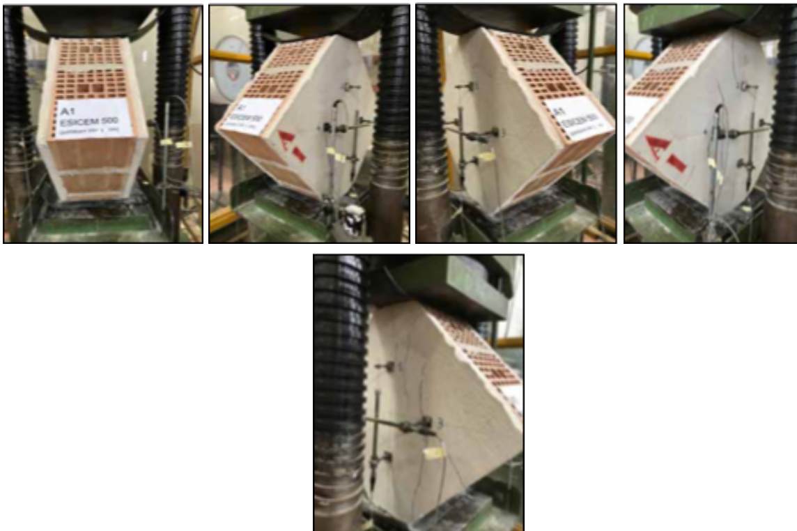
Figura 4.1 - Provino A 1.1 sotto la prova di compressione diagonale
