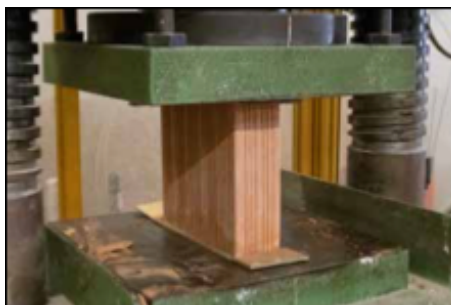
Figura 3.5 Prova di Compressione su un blocco Forato
