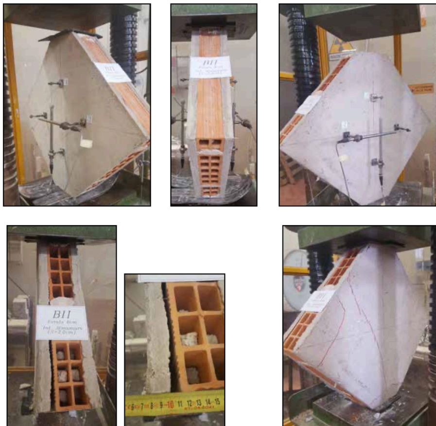
Figura 4.13 Provino B 2.1 sotto prova di Compressione Diagonale
