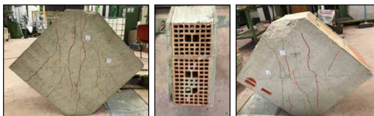
Figura 4.18 Provino D 1.1 sotto prova di Compressione Diagonale
