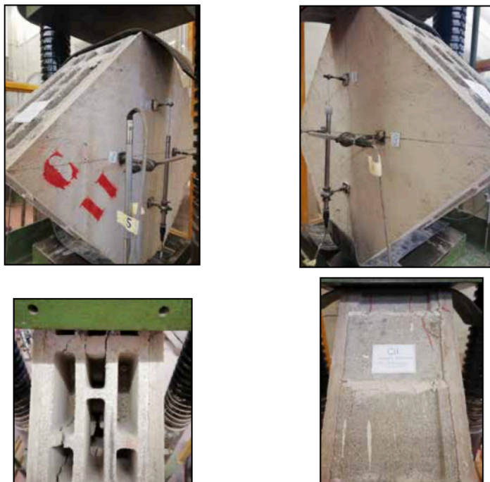
Figura 4.17 Provino C3.2 sotto prova di Compressione Diagonale
