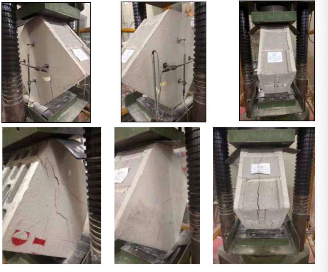
Figura 4.9 Provino C1.3 sotto prova di Compressione Diagonale
