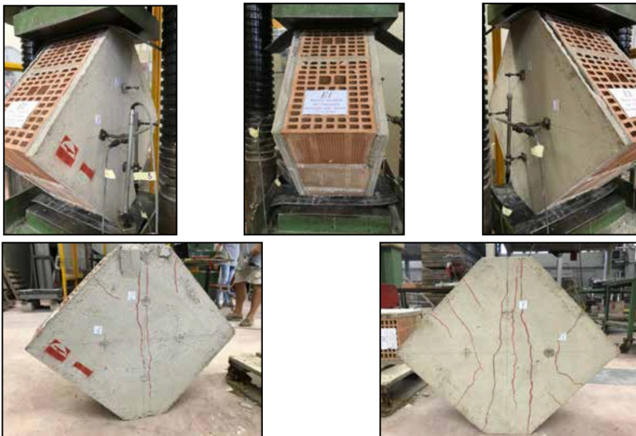
Figura 4.21 Provino E1.1 sotto prova di Compressione Diagonale
