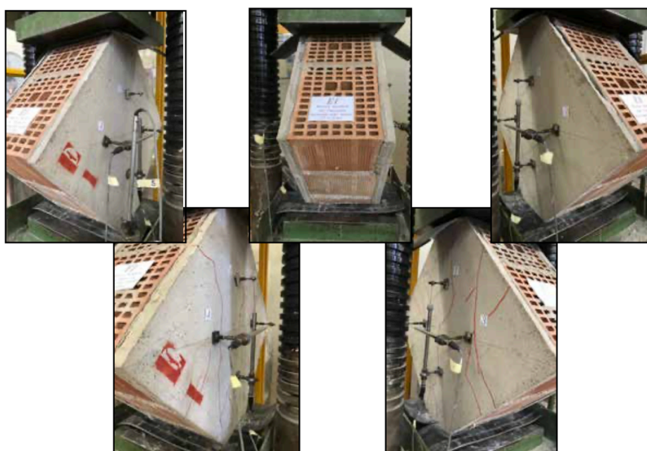
Figura 4.22 Provino E 1.2 sotto prova di Compressione Diagonale
