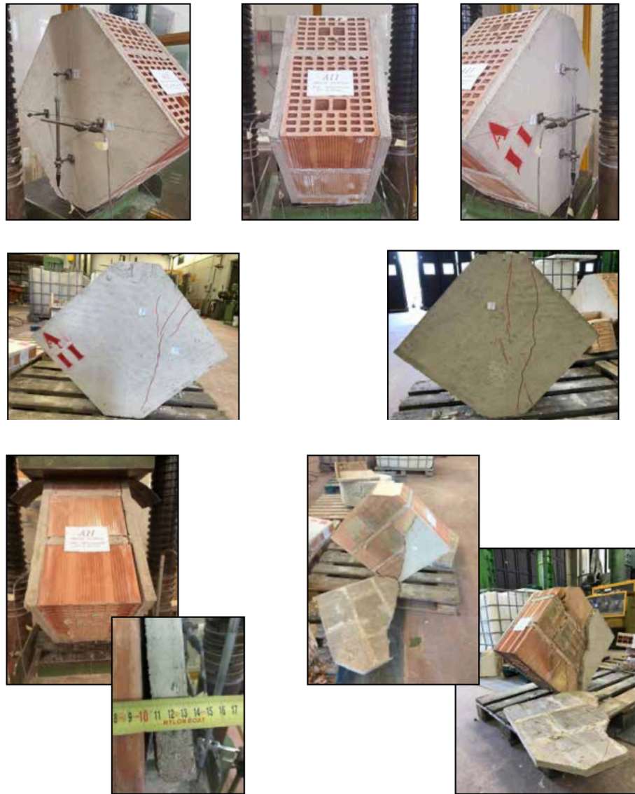
Figura 4.10 Provino A 2.1 sotto prova di Compressione Diagonale
