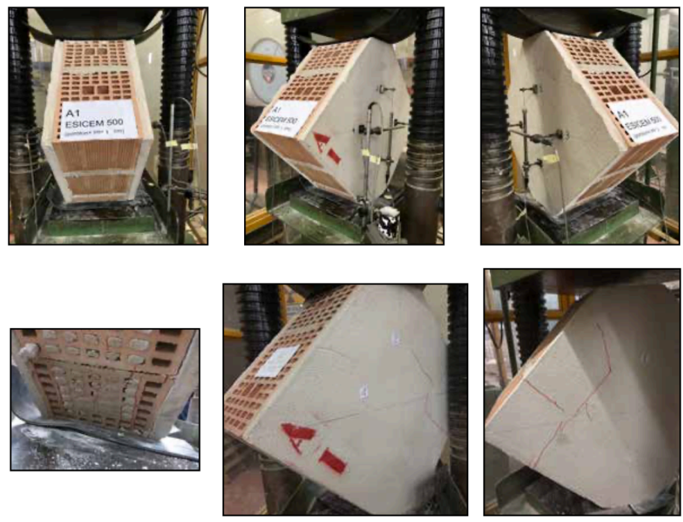
Figura 4.3 - Provino A 1.3 sotto Prova di compressione diagonale
