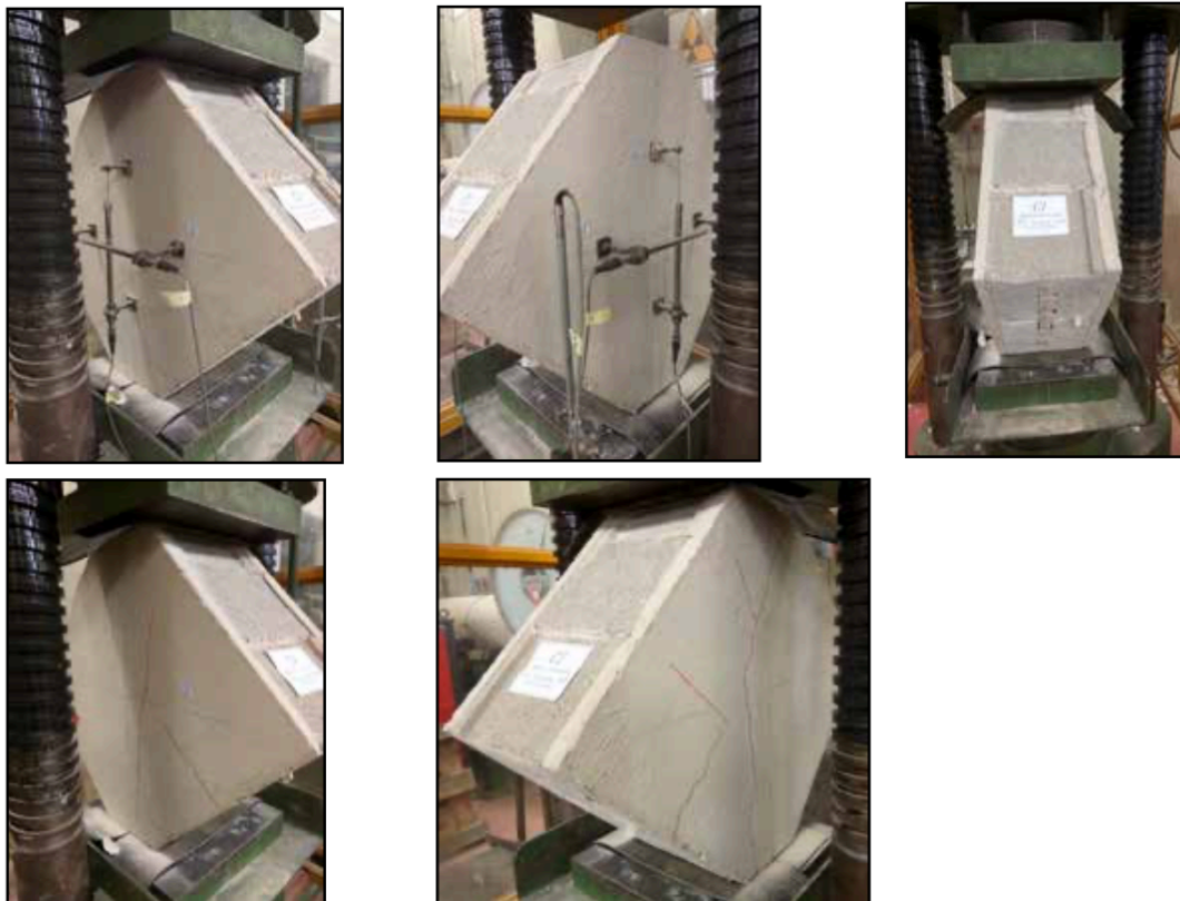
Figura 4.7 - Provino C1 sotto prova di Compressione diagonale
