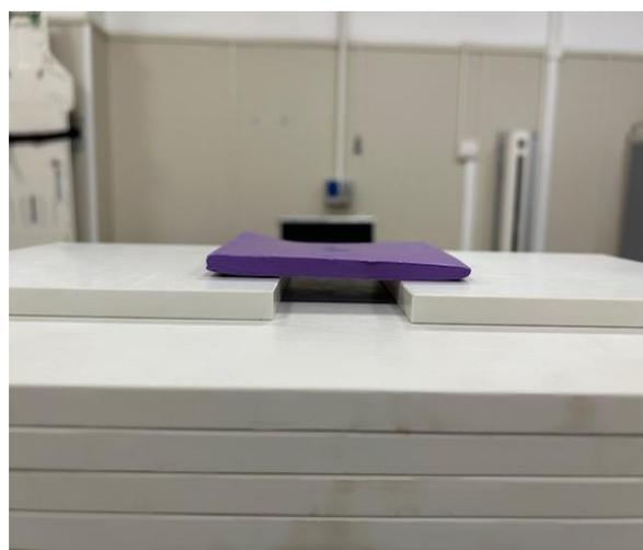
**Figura 10.** Strato di bolus con GAP d'aria da 1 cm.
