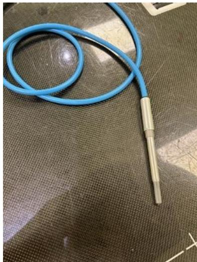
**Figura 3.** Camera a ionizzazione Farmer utilizzata per le misure dosimetriche.
