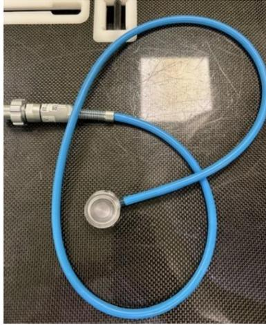
**Figura 4.** Camera a ionizzazione Advanced Markus utilizzata per le misure dosimetriche.
