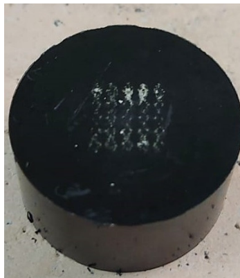
Figura 3.3 Provino acciaio 316l Dense-out inglobato
