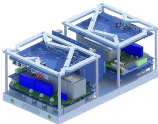
Figura 2.2: Il sistema di azionamento AMK KW26-S5-FSE-4Q impiegato sulla Peacock 5
