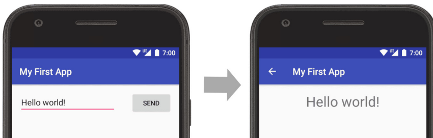
Figura 1.8. Un esempio di un intent, usato per il passaggio di dati da un'Activity a un'altra
