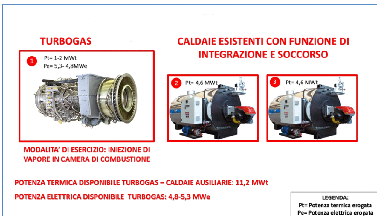
Fig. 4.1 - Configurazione impiantistica ante revamping
