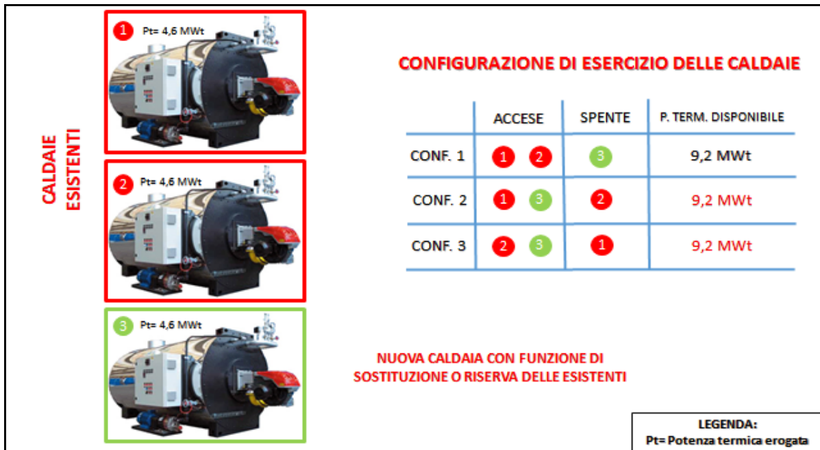
Fig. 4.3 - Configurazione di esercizio delle caldaie di integrazione e soccorso post revamping
