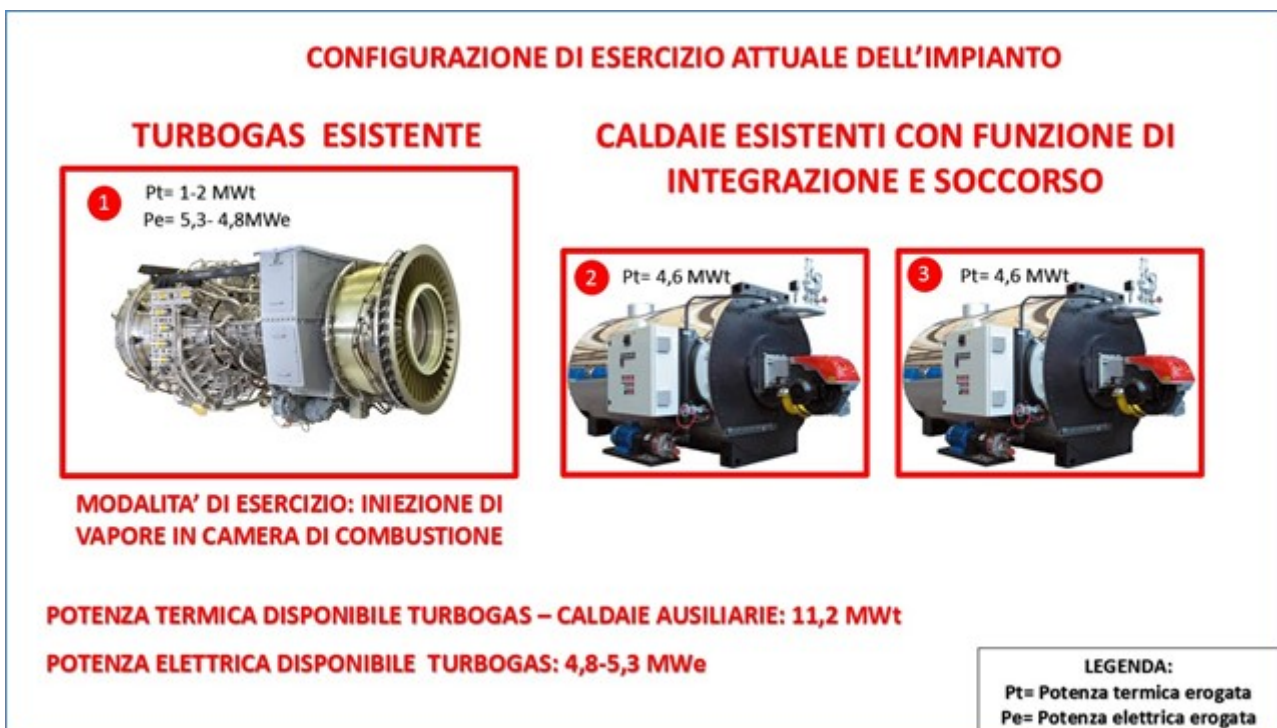
Fig. 5.8 - Attuale configurazione d'impianto e modalità d'esercizio
