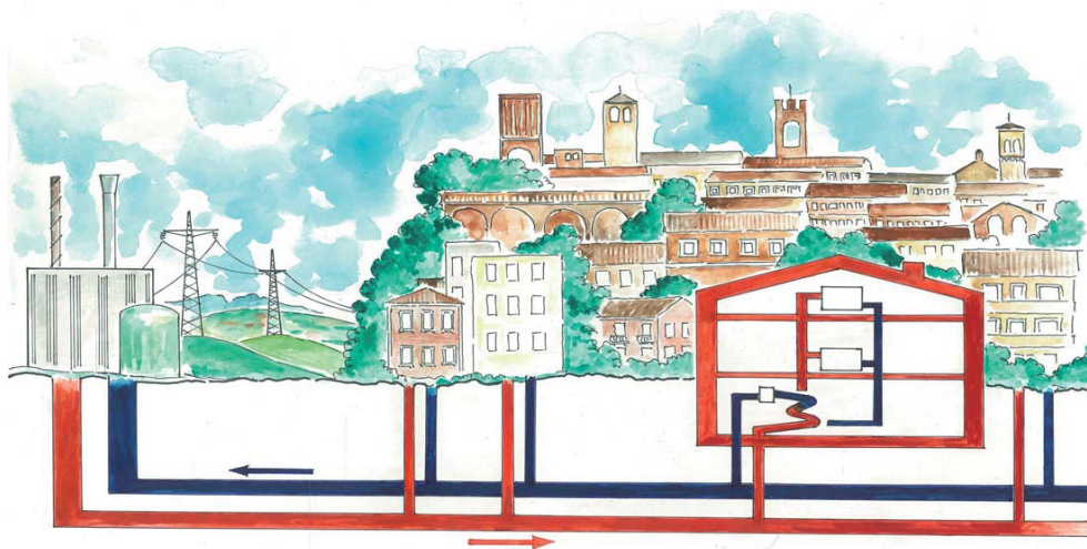
Fig. 2.13 - Schema funzionamento rete teleriscaldamento
