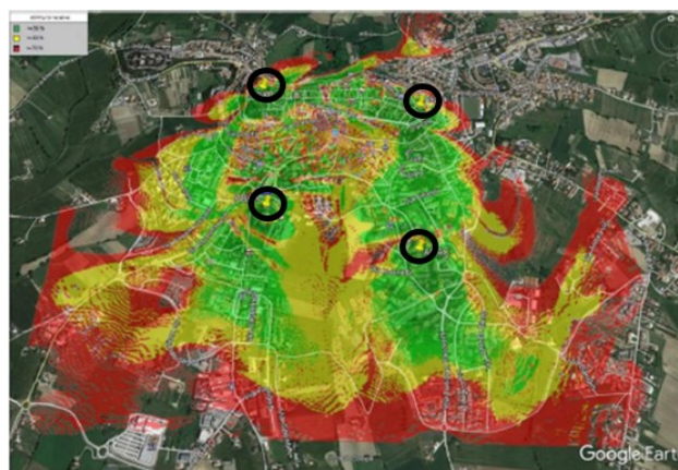
Fig. 6.16 Esploso delle zone raggiunte dal sistema fisso di telelettura dei dati degli Smart Meter
