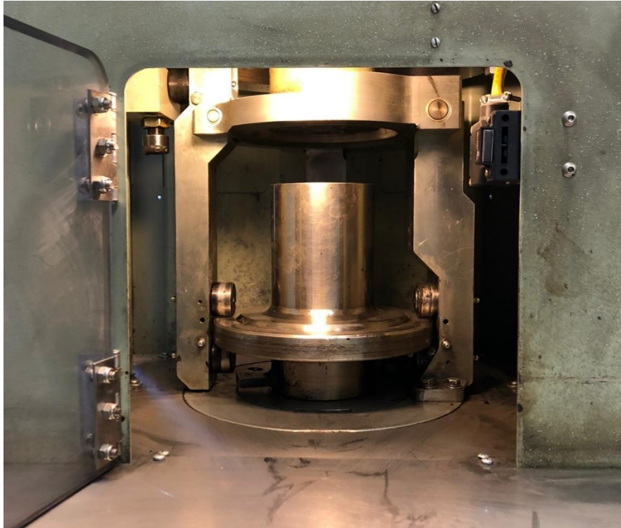
Figura 39: fustella inserita all'interno della pressa giratoria
