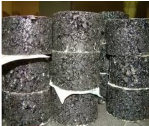
Figura 34: provini compattati in sito
