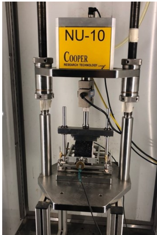
Figura 48: cella di carico NAT con provino posizionato pronto per la prova
