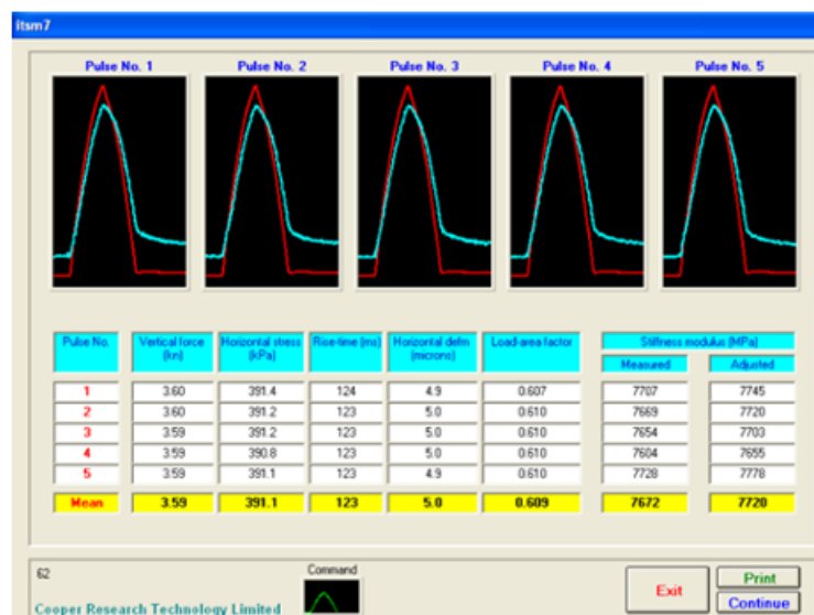
Figura 53: schermata finale per il calcolo del modulo di rigidità medio ottenuto da 5 valori determinati
