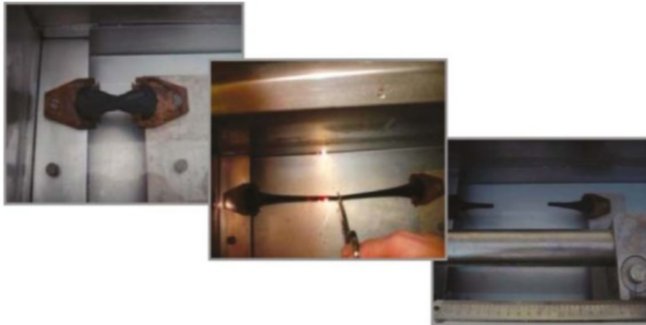
Figura 15: prova di duttilità
