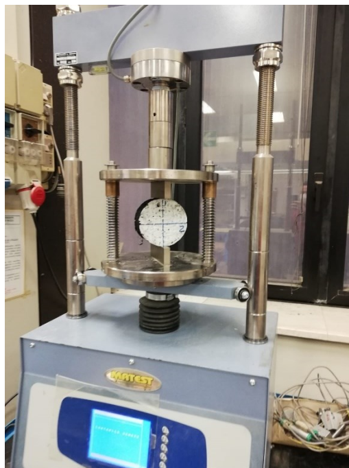
Figura 56: provino posizionato correttamente nell'apparecchio
