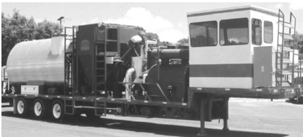
Figura 28: Esempio di impianto mobile per la produzione di asphalt rubber
