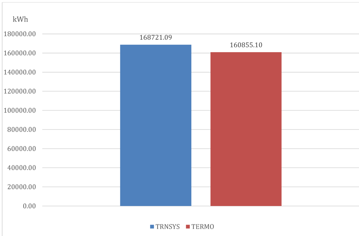
Figura 94- Confronto dei fabbisogni del piano primo ricavati da TRNSYS e Termo
