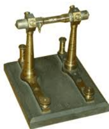
Figura 1.4: Coherer di Branly
