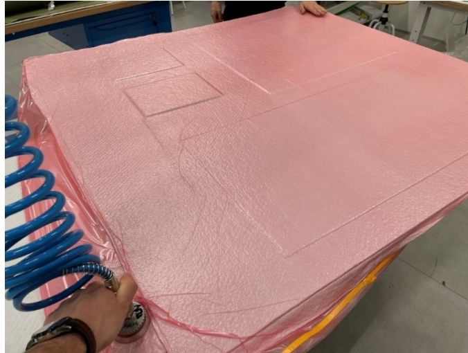
Figura 3.10. Applicazione del vuoto al sacco contenete lo stampo e i vari ply applicati
