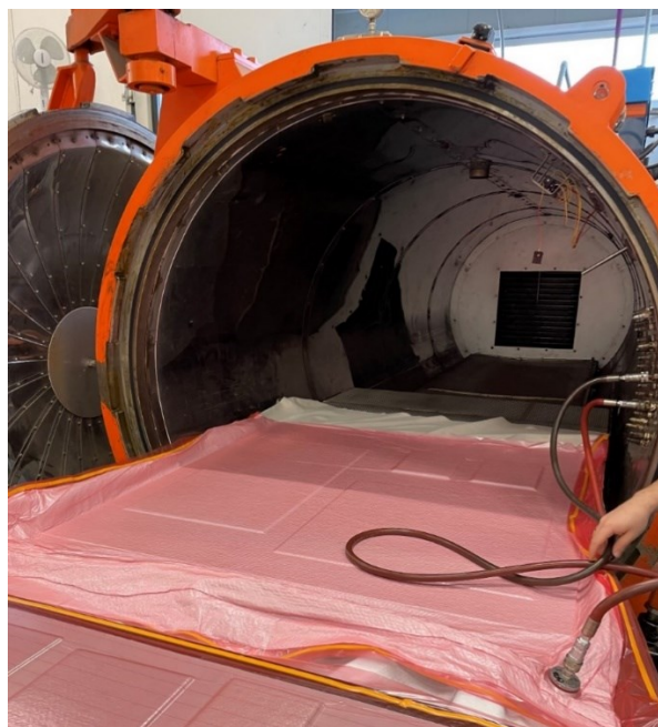
Figura 3.11. Inserimento dello stampo base preparato all'interno dell'autoclave
