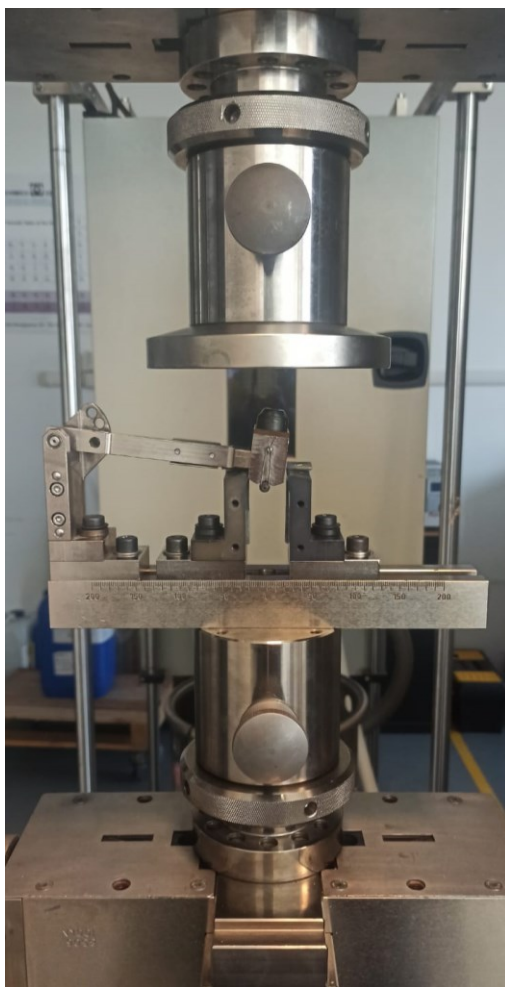
Figura 3.29. Configurazione della prova di taglio interlaminare
