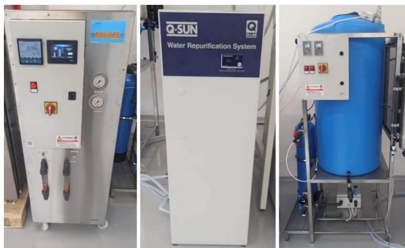
Figura 3.20. Demineralizzatore, purificatore e serbatoio d'accumulo di acqua dello Xenon test
