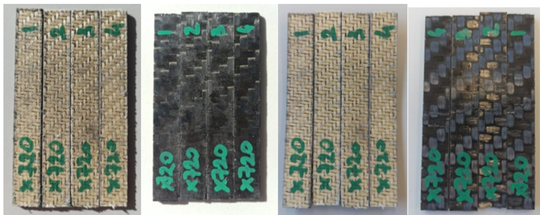
Figura 4.30 Provini condizionati per 720 ore nello Xenon test, prima e dopo la prova di flessione
