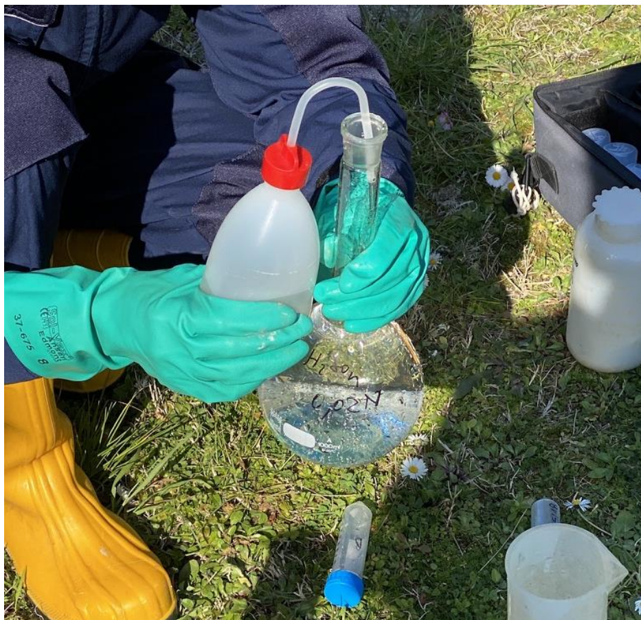
Figura 2.2.1.5 Scioglimento di 1 grammo e 3 grammi di sale per la calibrazione della sonda
