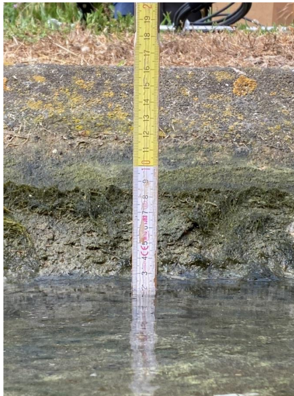
Figura 3.2.2.1 Misurazione della profondità dell'alveo
