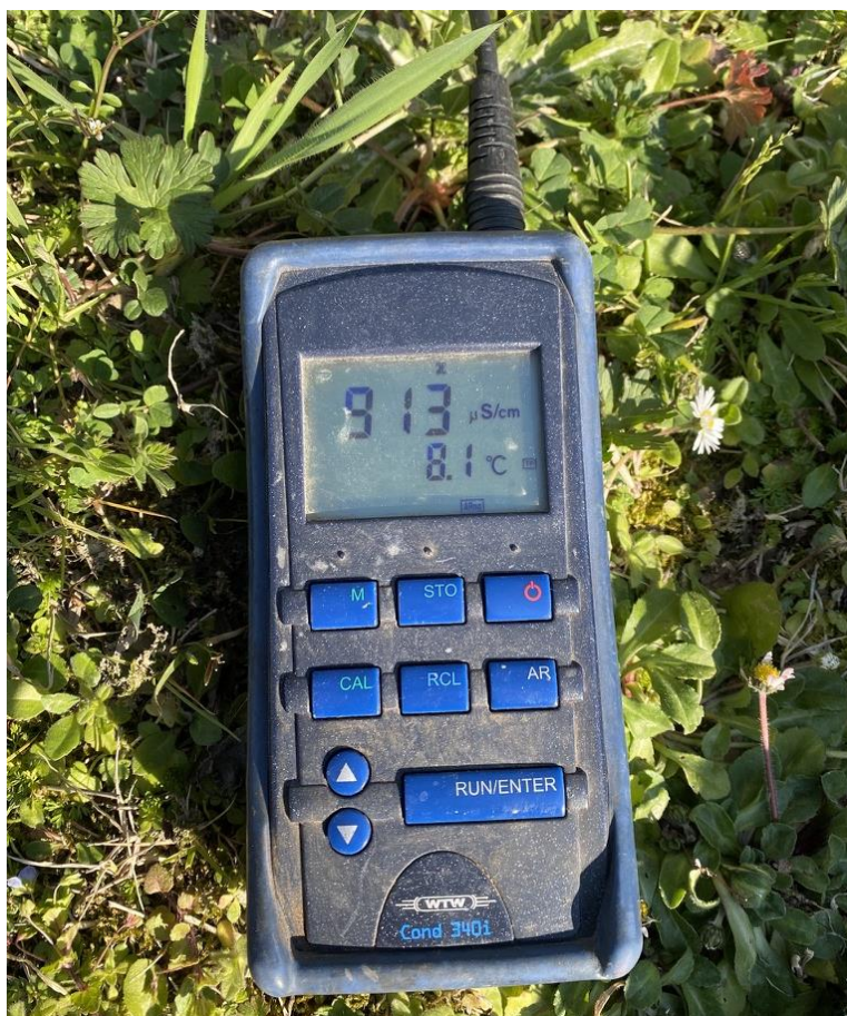
Figura 2.2.1.3 Conducimetro utilizzato per controllare l'andamento della conducibilità elettrica
