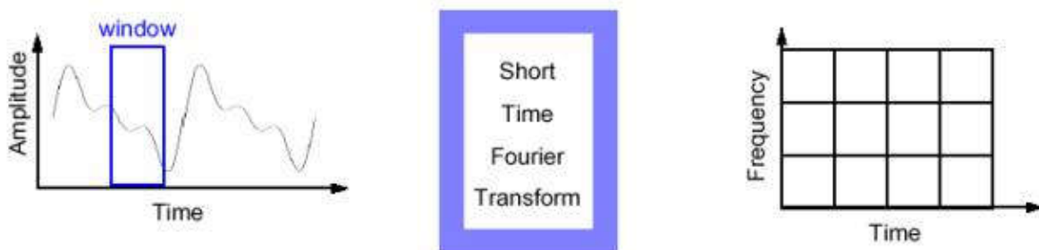
Figura 3.6: analisi con Short Time Fourier Transform
