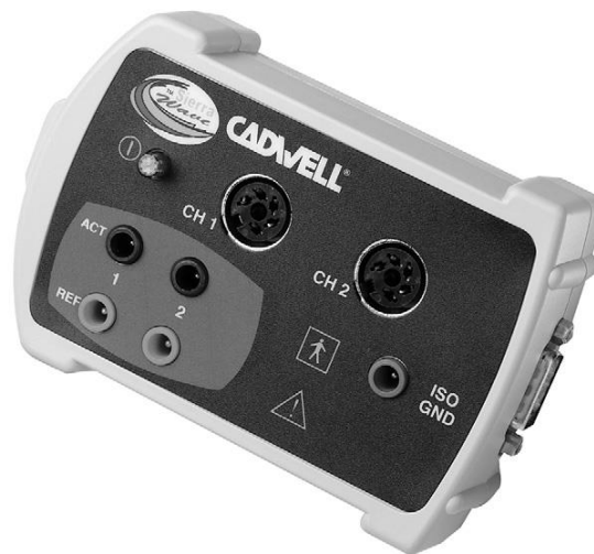
Figura 2.8: Preamplificatore per EMG
