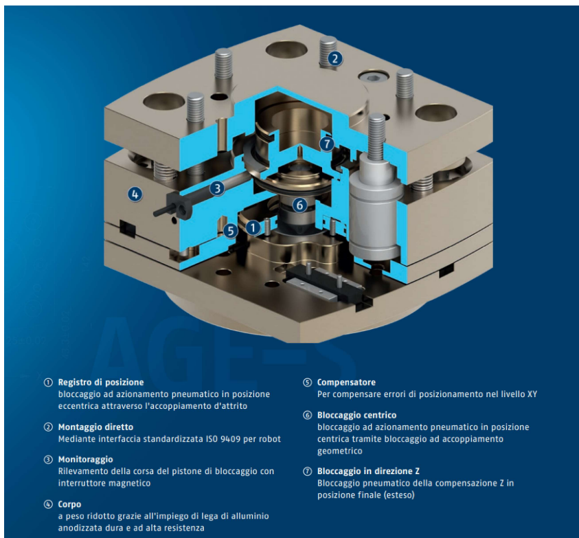
Figura 2.47: unità di compensazione
