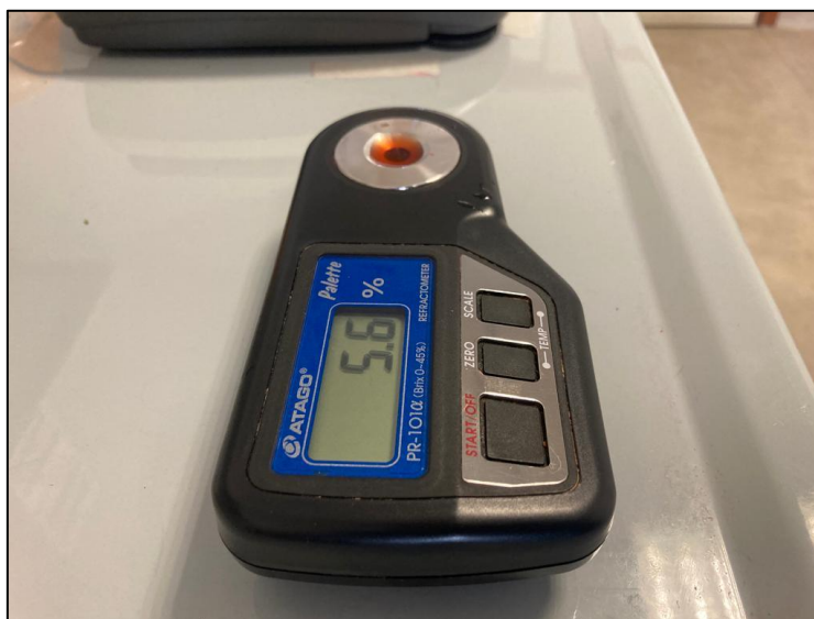
Figura 8: rifrattometro digitale a compensazione automatica della temperatura Atago, PR101 \alpha
