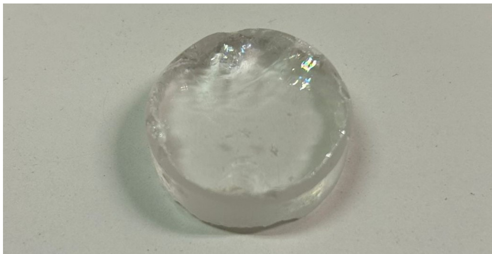
Figura 5.6 Immagine di un cristallo anisotropo a forma di cilindretto preso come cristallo di prova per il progetto e validazione del sistema ottico
