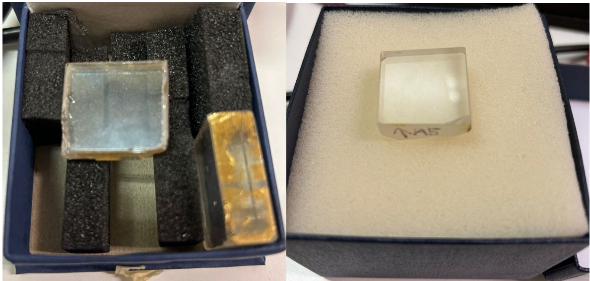
Figura 5.9 Immagini dei due campioni analizzati di un cristallo anisotropo PWO Valera
