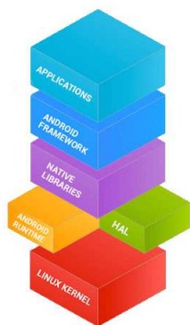
Figura 2.5. I cinque livelli dell'architettura Android
