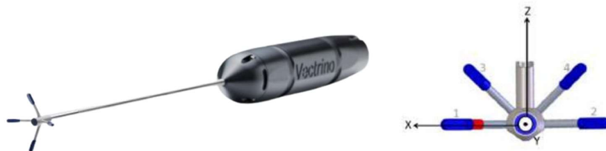
Figura 19: Misuratore di velocità ADV e relativo sistema di coordinate.
