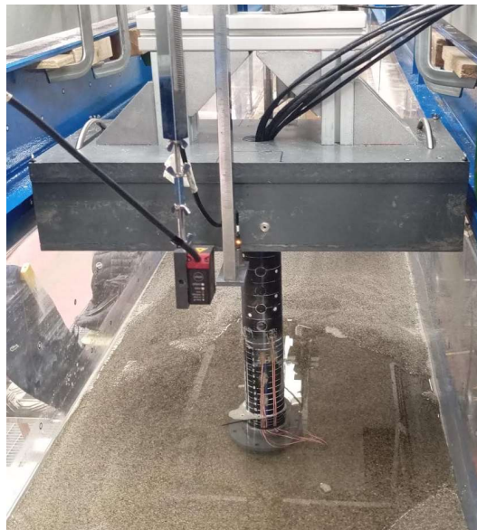
Figura 34: Pila svincolata dal terreno.
