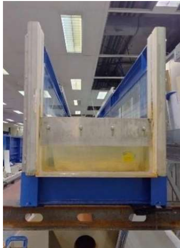
Figura 14: Paratoia di valle del canale idraulico.
