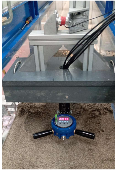
Figura 70: Dinamometro collegato alla pila dell'impalcato.
