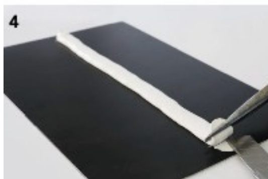
Figura 16 - Fissare la parte da testare utilizzando morsetti adeguati. Successivamente, servendosi di un cutter affilato, separare dal substrato i primi 3 cm del bordo d'attacco del cordolo
