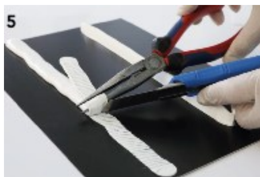
Figura 17 - Afferrare la parte separata del cordolo con una pinza a becchi d'ago e ruotare lentamente il cordolo (applicando uno sforzo di pelatura) per separarlo dal substrato. Tagliare frequentemente l'adesivo sul fondo, fino a raggiungere il substrato
