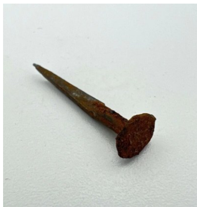
Figura 6 - Chiodo usato per collegare le tavole allo scheletro
