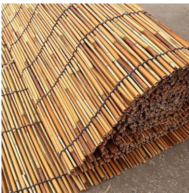
Figura 1 -Dettaglio di fasci di canne legati con fibre vegetali
