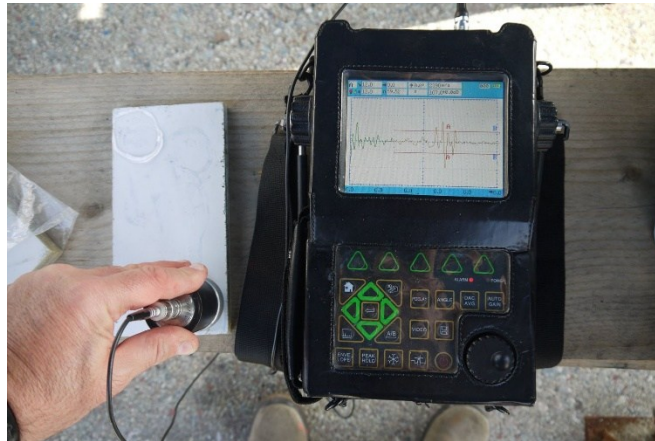
Figura 25 - applicazione degli ultrasuoni su un provino metallico
