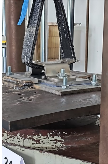
Figura 18 - test di trazione su un provino con stesura della colla perfettamente eseguita
