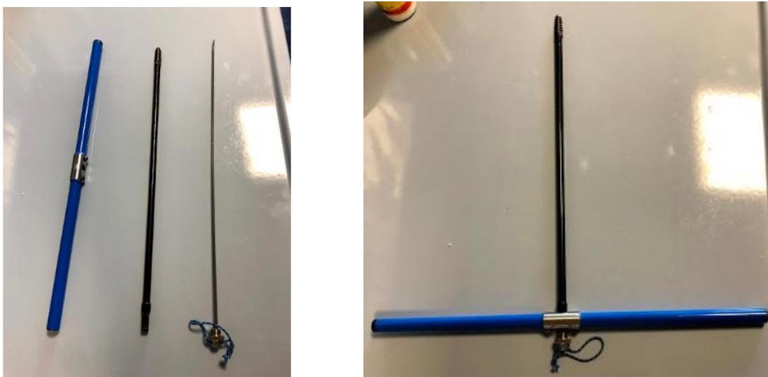
***Figura 2.2.2.1 A sinistra i componenti della trivella Pressler smontata; a destra la trivella Pressler pronta per essere utilizzata.***
