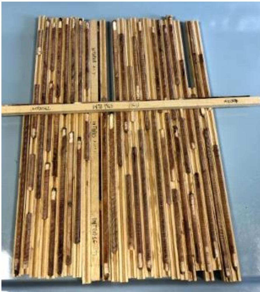
**Figura 2.3.1.1** carote di Internone incollate su appositi supporti con codice identificativo
