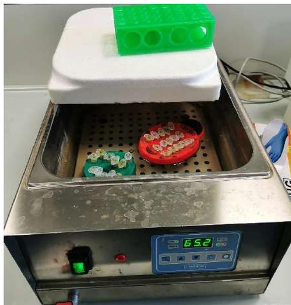
*Figura 8: Incubazione tramite bagno di acqua calda.*
