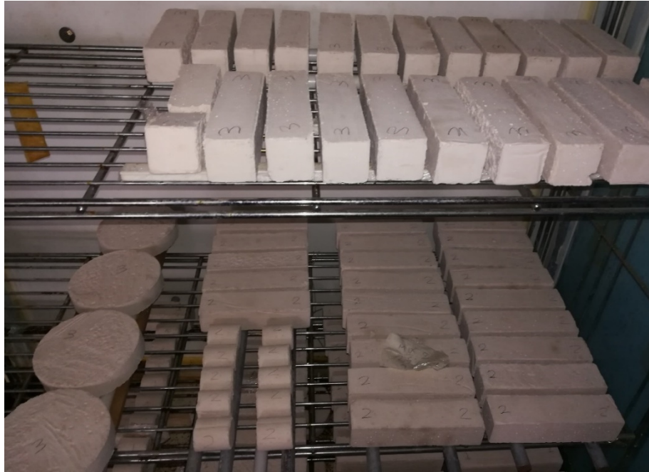
Fig. 13: stagionatura di una parte dei campioni durante la seconda fase di maturazione.
