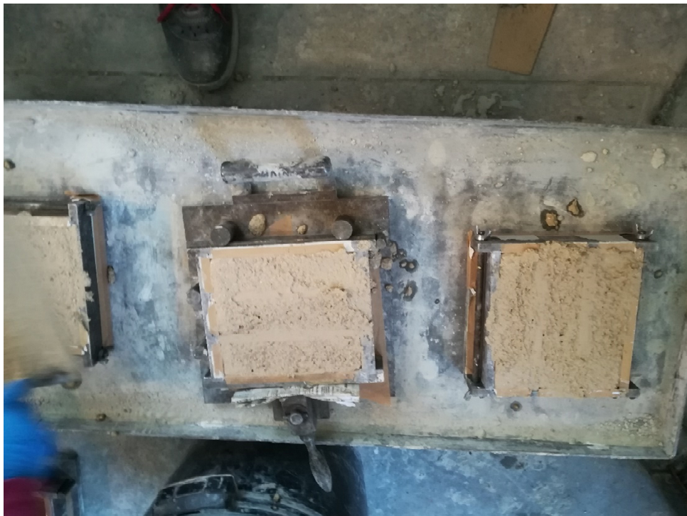
Fig. 12: malta gettata nei casseri e posizionata sul tavolo vibrante per completare il costipamento.
