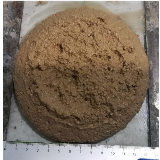
Fig. 18: nel mix 3 si ottiene uno spandimento di 130 e 136 mm.
