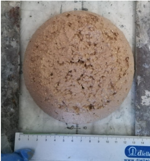
Fig. 16: nel mix 1 si ottiene uno spandimento di 133 e 134 mm.
