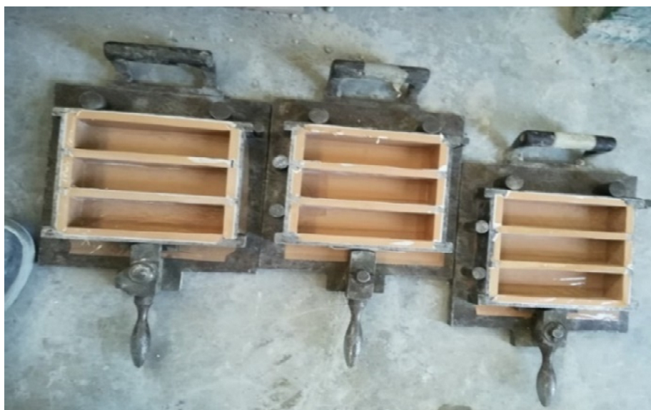
Fig. 9: casseri rivestiti internamente di nastro adesivo.
