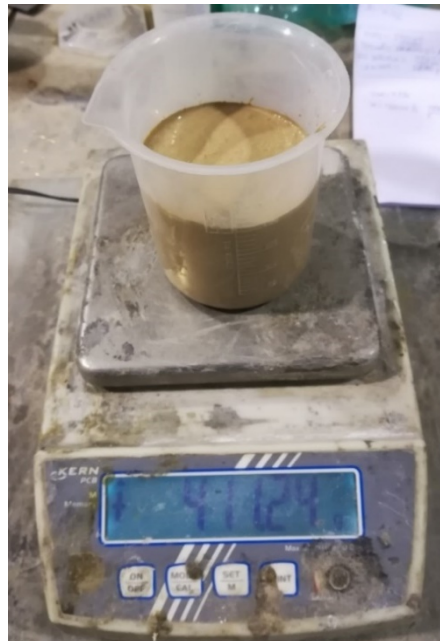
Fig. 20: determino la massa del recipiente con 200 cm 3 all'interno utilizzando una bilancia.
