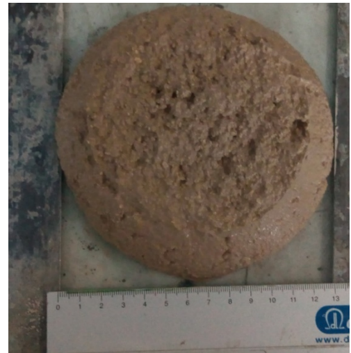
Fig. 19: nel mix 4 si ottiene uno spandimento di 136 e 137 mm.
