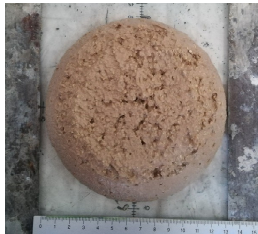
Fig. 17: nel mix 2 si ottiene uno spandimento di 132 e 133 mm.
