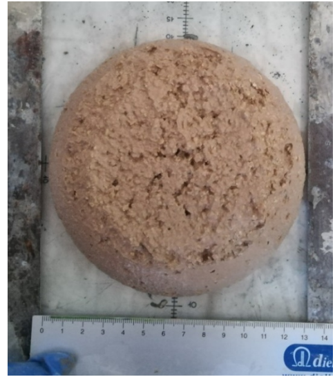
Fig. 16: nel mix 1 si ottiene uno spandimento di 133 e 134 mm.
