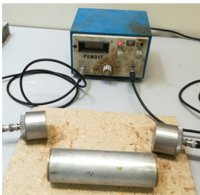
Fig. 26: PUNDIT e cilindro metallico per tararlo.
