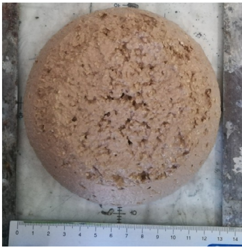
Fig. 17: nel mix 2 si ottiene uno spandimento di 132 e 133 mm.
