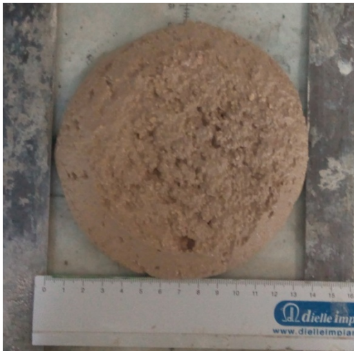
Fig. 19: nel mix 4 si ottiene uno spandimento di 136 e 137 mm.
