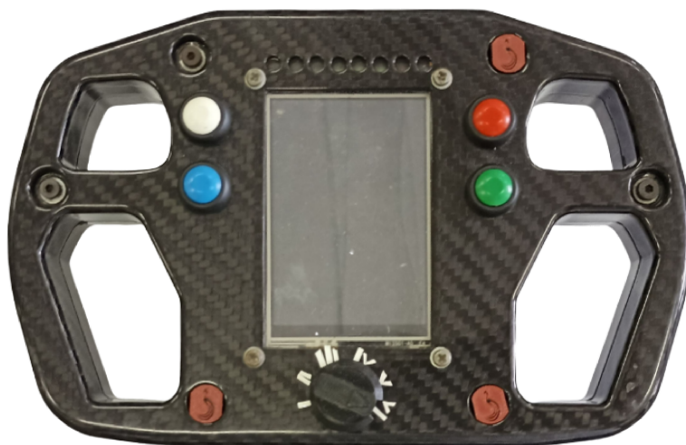
Figura 3.1: Volante a guscio in fibra di carbonio della P4 EVOLUZIONE
