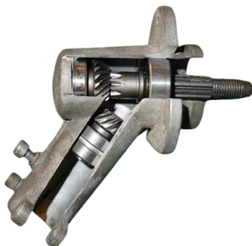
Figura 3.17: Coppia conica sezionata, dal canale YouTube Moto Servis
