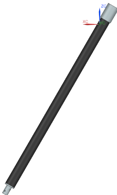
Figura 3.34: Modello 3D del tubo obliquo completo di inserti
