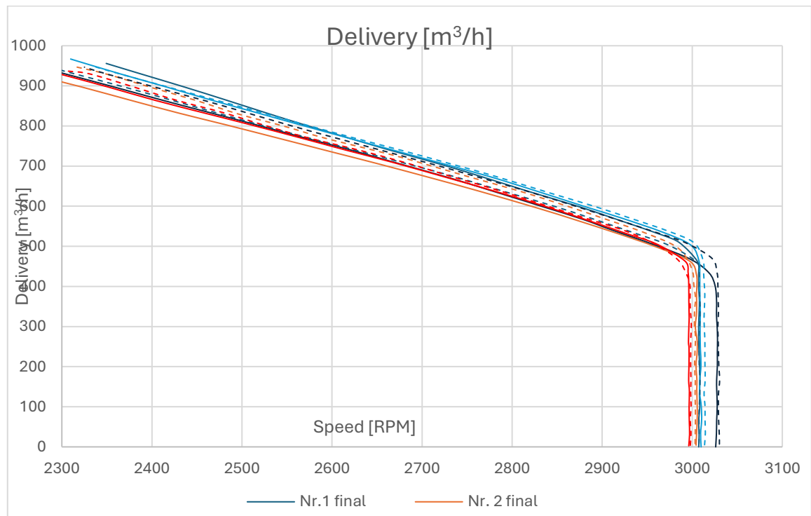
Figura 11 Confronto test di Portata-prevalenza prima e dopo il Life Test
