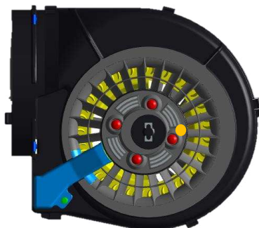
Figura 8 posizionamento accelerometro sulla coclea
