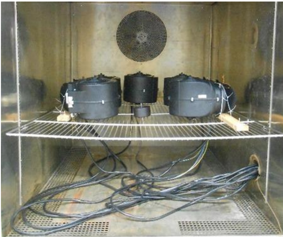
Figura 10 setup dei motori elettrici nella camera climatica
