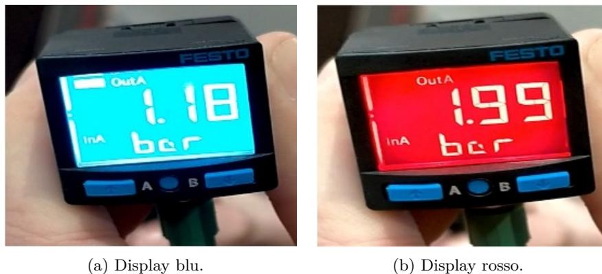
Figura 2.3: Display LED a due colori del sensore FESTO
